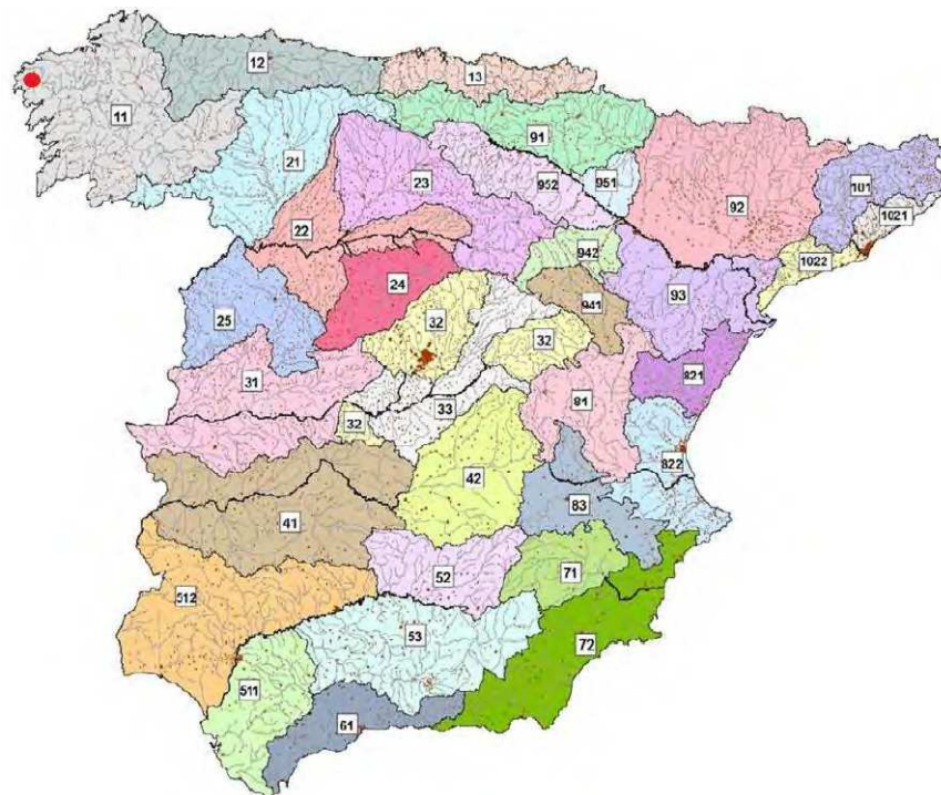
Regiones consideradas para la caracterización del coeficiente corrector del umbral de escorrentía (Fuente: Norma 5.2-IC Drenaje Superficial)
