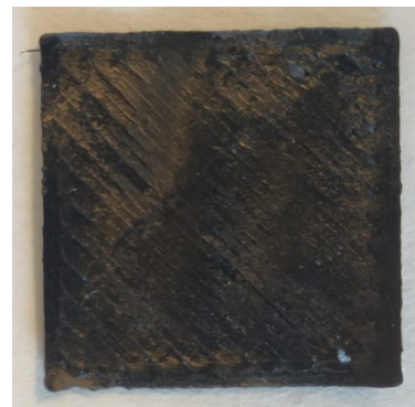
Figura 8.21 – Placa impresa de PPr_8CNT
