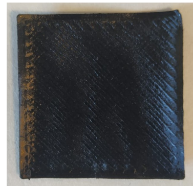
Figura 8.17 – Placa impresa de PPm_8CNT
