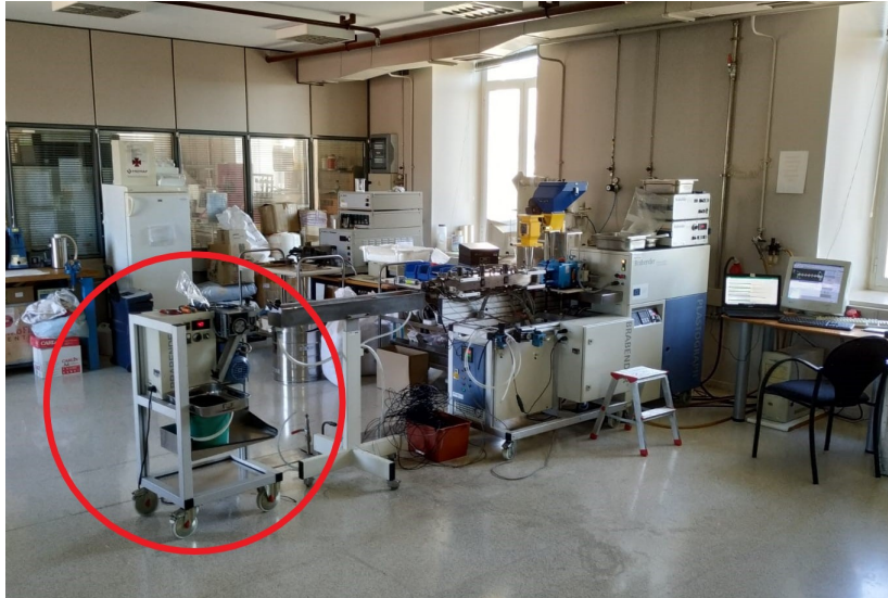
Figura 7.8 – Extrusora bihusillo DSE 20 incluyendo la granceadora
