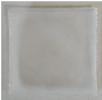
Figura 8.13 – Placa impresa de PPm
