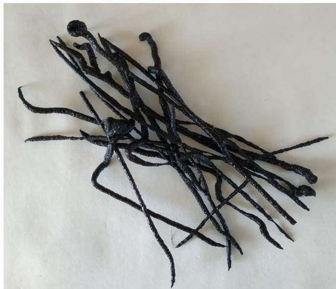
Figura 7.10 – Filamento de PPis_5CNT
