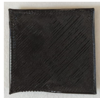
Figura 8.28 – Placa impresa boq.0,4mm, ec=0,3mm
