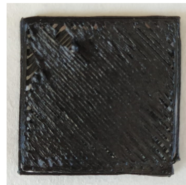
Figura 8.30 – Placa impresa boq.0,6mm, ec=0,3mm
