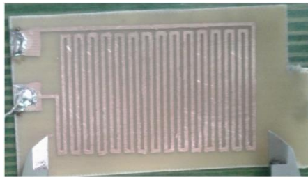
Figura 11. Pistas tipo meandro impresas en PCB. Tomado de [9].
