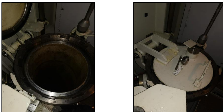
Figura 8: Ejetor de lixo com a porta interior aberta e com a porta interior fechada de um submarino da classe Tridente.
