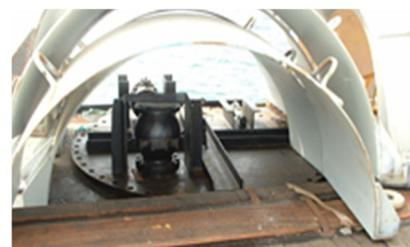
Figura nº 57 – Tampa de afundamento e abraçadeiras laterais.
