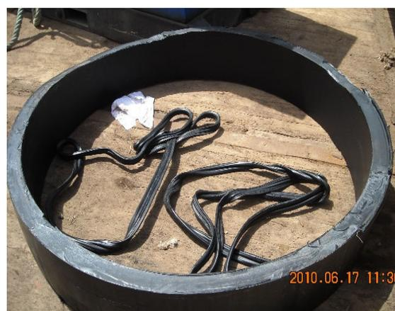
Figura nº 128 – Soldadura que colapsou.
