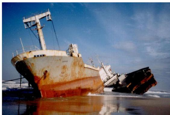
Figura nº 121 – “Courage” quebrado em duas partes.
