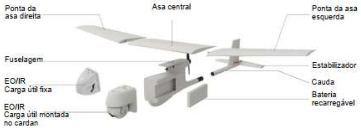
Figura 3 - Componentes e módulos do VANT Raven B
