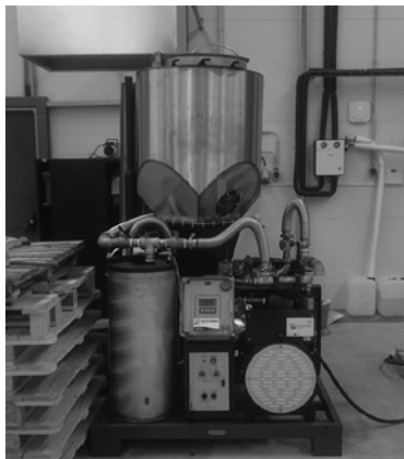
Figura 27 – Fotografia de um gaseificador do tipo de leito fixo de fluxo de ar descendente (downdraft), instalado no Instituto Politécnico de Portalegre.
