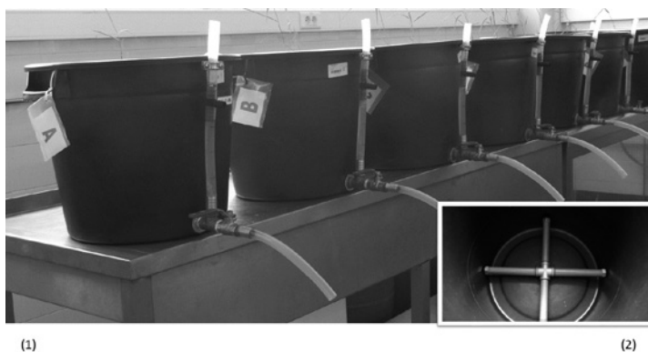
Figura 14 – Fotografias dos vasos usados para a construção das ZHCs laboratoriais (1), e pormenor do sistema interno de drenagem (2).
