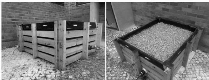
Figura 35 – Fotografias de um protótipo de ZHC modular 1×1 construído com quatro elementos de madeira.
