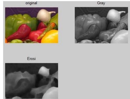
**Gambar 5 Pengolahan Gambar Dengan Cara Erosi**
