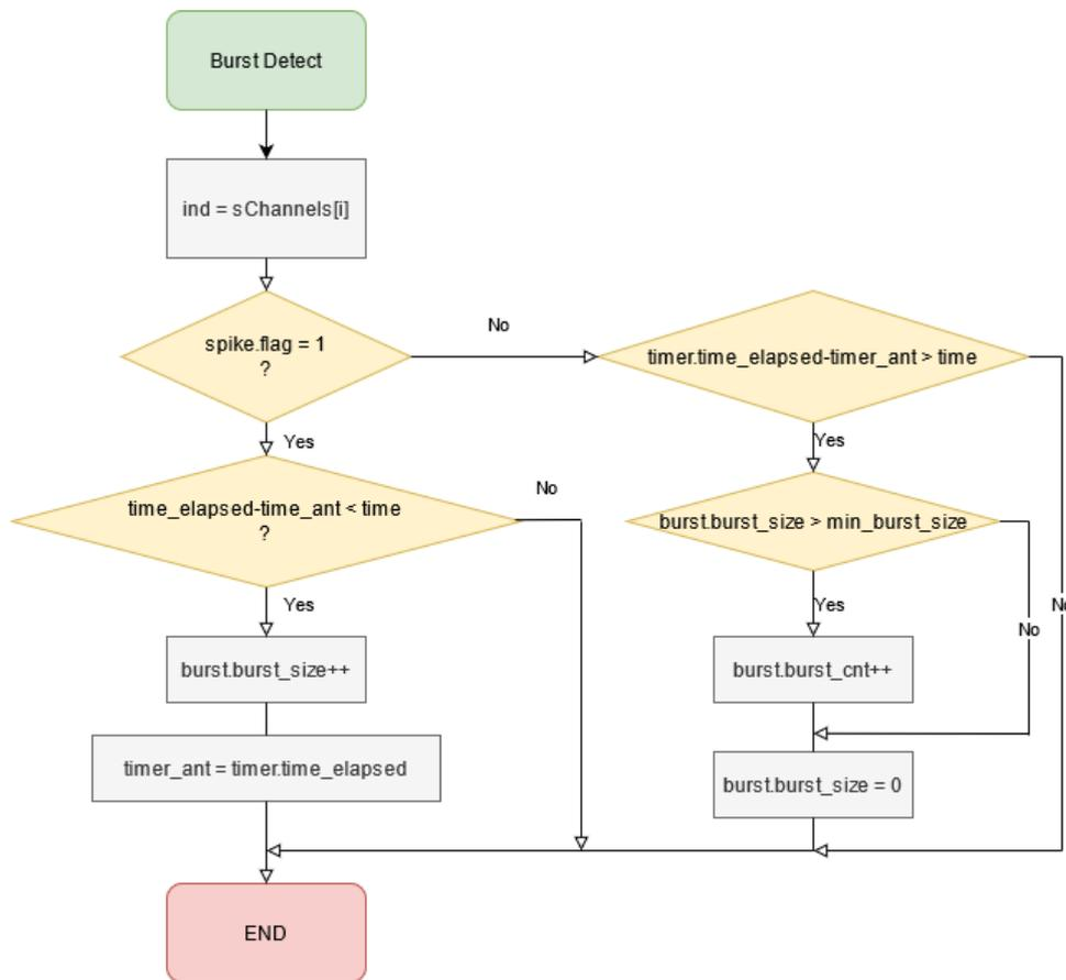
Figura 4.4: Algoritmo de Detecção de *Bursts*
