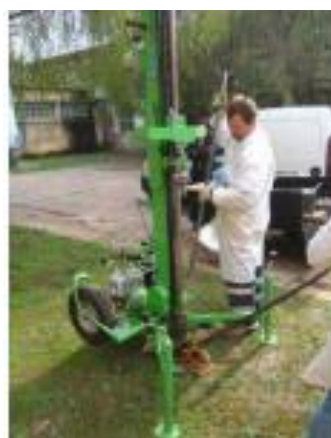
Figura 8 - Exemplo de recolha de amostras com trados de cravação dinâmica (Costa, Brito, Vendas, Lopes, & Caramelo, 2015)
