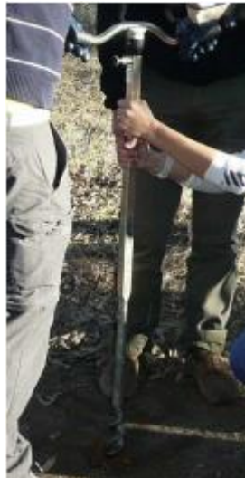
Figura 7 - Exemplo da recolha de amostras com trados ligeiros (Costa, Brito, Vendas, Lopes, & Caramelo, 2015)
