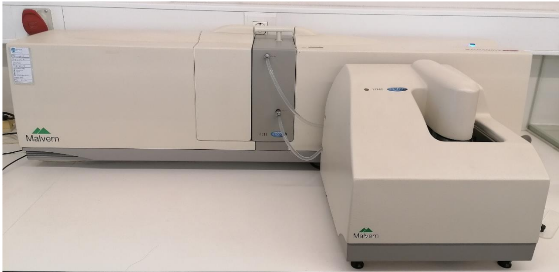
Figura 14 - Granulómetro de raios laser MS2000 Hydro G da Malvern
