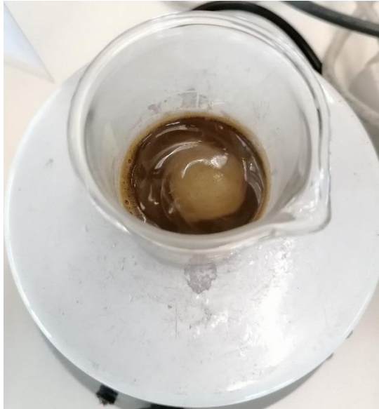
Figura 15 - Aspeto da mistura da amostra de solo com água no agitador magnético no ensaio de determinação do pH
