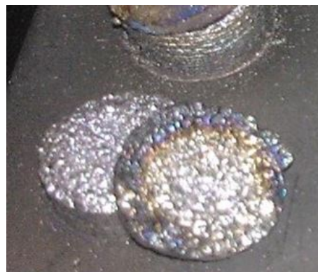
Figura 2.59 Delaminação em peças de Ti64 fabricadas por LENS do substrato de AISI 410 [100]
