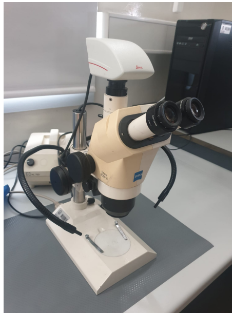
Figura 3.20 Zeiss Stemi 2000-C utilizado para obtenção de imagens dos cordões de 18Ni300 em H13
