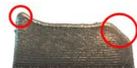
Figura 2.65 Vista lateral de deformações nas extremidades da superfície de uma peça feita de liga Co-Cr-Mo por DED [100]
