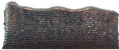
Figura 2.68 Vista lateral da variação de altura de uma peça feita de liga Co-Cr-Mo por DED [100]
