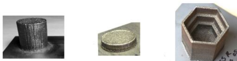
Figura 2.61 Construções com rugosidades superficiais elevadas [100]
