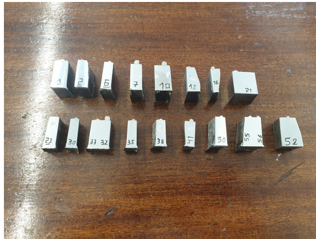
Figura 3.18 Cordões de 18Ni300 em H13 selecionados para análise morfológica
