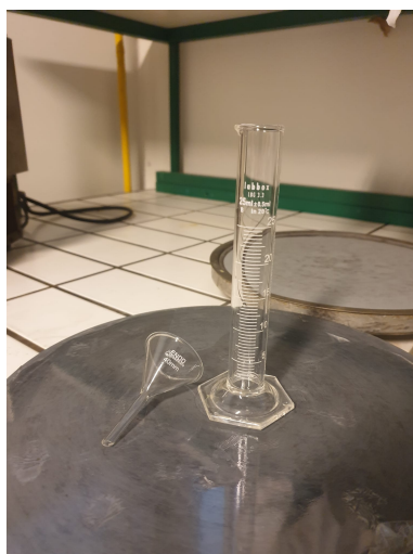
Figura 3.3 Proveta e funil utilizados na medição da fluidez do pó
