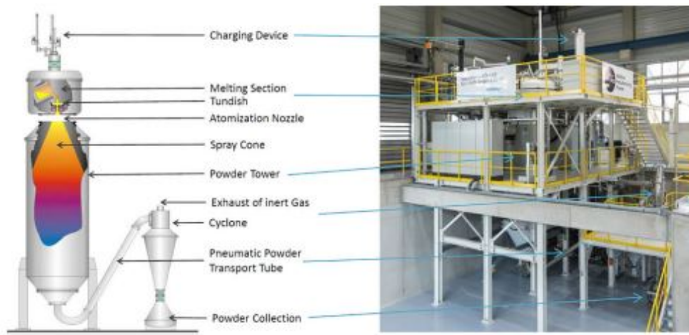
Figura 2.21 Componentes duma máquina de atomização a gás com sistema close coupled [48]
