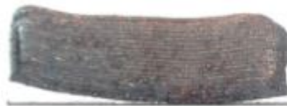
Figura 2.67 Vista lateral de uma peça feita de liga Co-Cr-Mo por DED separada do substrato por deformação excessiva [100]
