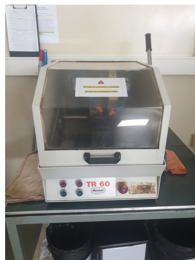
Figura 3.22 Remet TR-60 utilizada para o corte dos dos planos de 18Ni300 em H13 e em CK45
