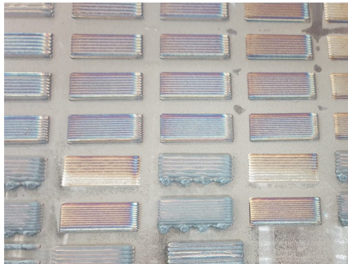
Figura 2.70 Descoloração resultante da oxidação em camadas de AISI H13 depositado em AISI H13
