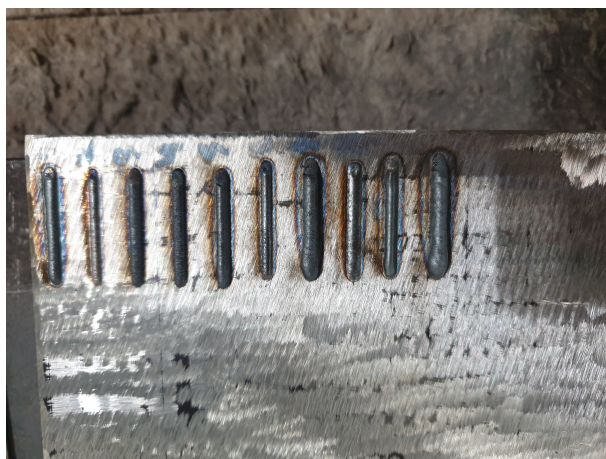
Figura 3.14 Primeiros 10 cordões de 18Ni300 depositados no H13 numerados de forma crescente da esquerda para a direita
