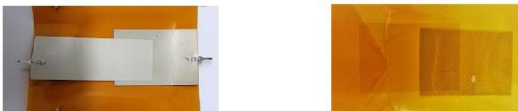
Figura 35. Dispositivo impresso por camadas. À esquerda, elétrodos de prata, impresso por serigrafia, e camada piezoelétrica de P(VDF-TrFE), impressa por *stencil* com espessura entre 25 - 30  $\mu\text{m}$ , similarmente, mas com elétrodos de PEDOT:PSS, imagem da direita.
