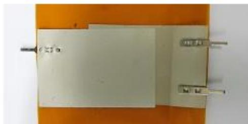
Figura 33. Dispositivo impresso por camadas. Elétrodo inferior e superior de prata, impresso por serigrafia, e camada piezoelétrica de P(VDF-TrFE), impressa por *stencil* com espessura entre 10 - 15  $\mu\text{m}$ .
