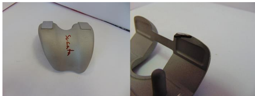
Figura 39 – Defeito detetado na peça 31R11 rejeitada na inspeção visual
