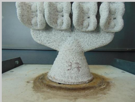
Figura 33 - Marcação dos cachos do lado para onde se realiza a rotação do forno
