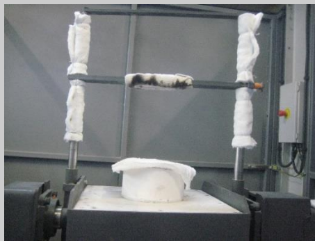
Figura 32 - Tampa do forno para proteção durante a fusão
