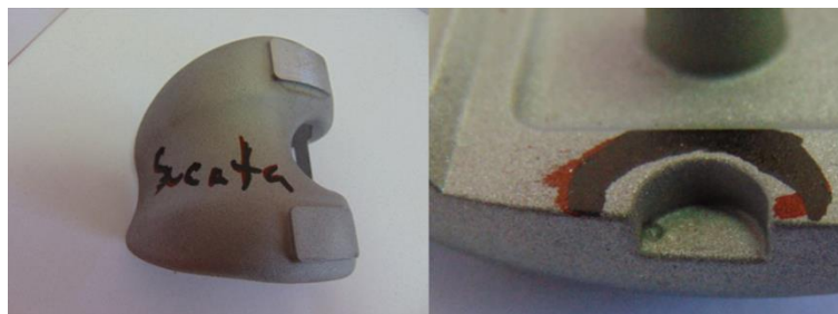
Figura 41 - Defeito detetado na peça 33R22 rejeitada na inspeção visual
