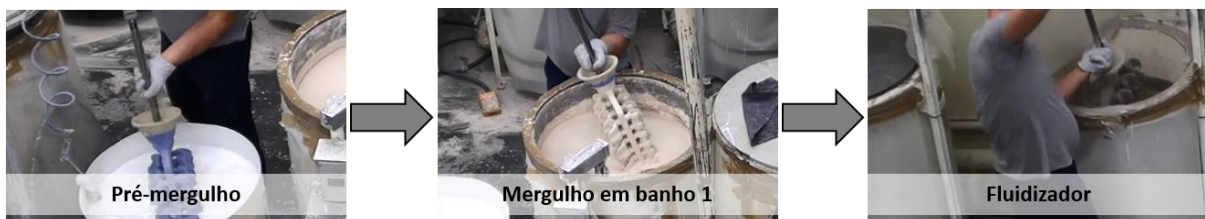
Figura 21 - Revestimento manual da segunda camada
