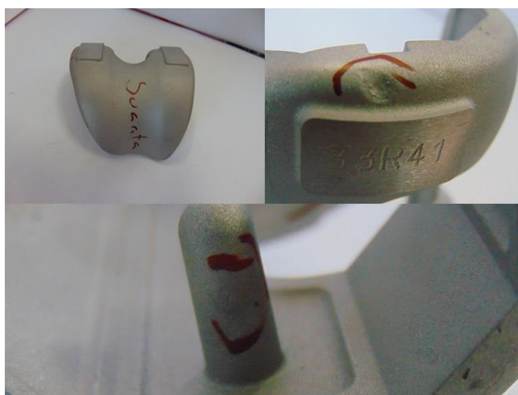
Figura 42 – Defeitos detetados na peça 33R41 rejeitada na inspeção visual
