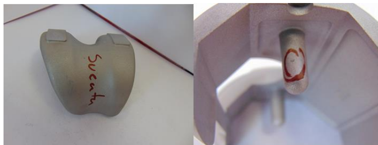
Figura 46 - Defeito detetado na peça 38L23 rejeitada na inspeção visual
