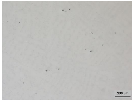
Figura 53 – Microrechupe observado na peça 32L32
