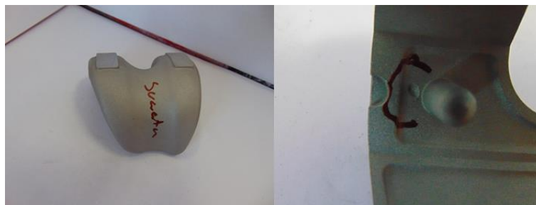
Figura 40 - Defeito detetado na peça 33L21 rejeitada na inspeção visual
