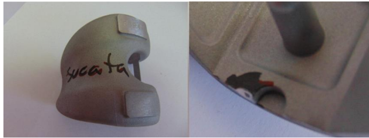
Figura 44 - Defeito detetado na peça 34R44 rejeitada na inspeção visual
