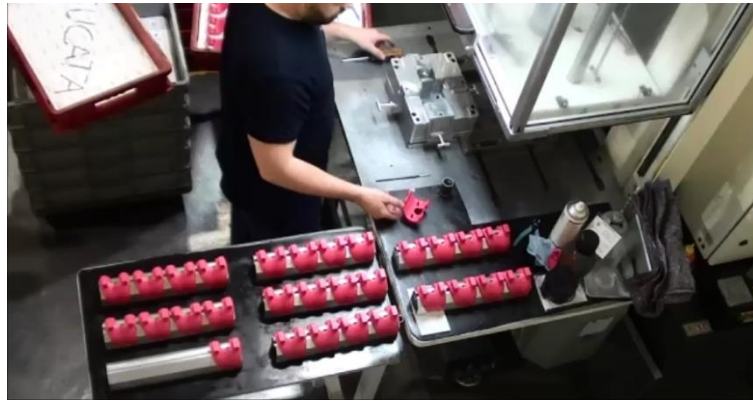
Figura 18 - Injeção em cera de próteses femorais e arrefecimento em “gabarits”
