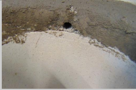
Figura 31 - Saída de Árgon para proteção do banho
