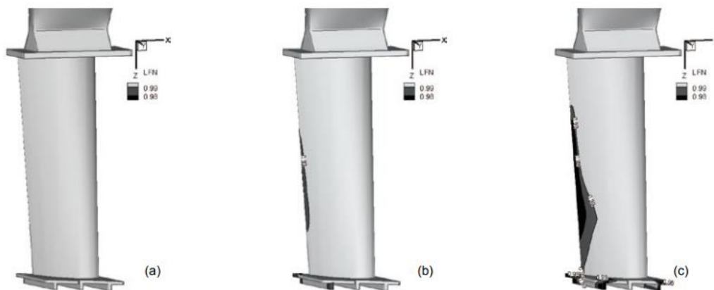
Figura 7 - Efeito da temperatura de pré-aquecimento da moldação na solidificação prematura do metal fundido (Djambazov and Pericleous 2011)
