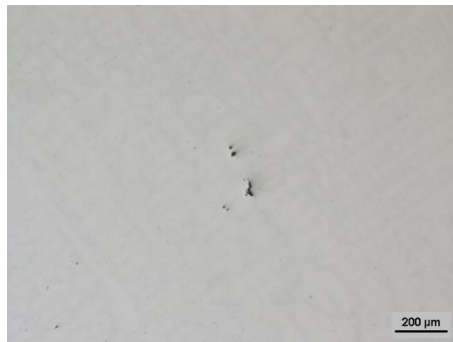
Figura 54 - Microrechupe observado na peça 32L32
