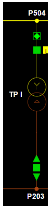
Figura 5.6: Painel do Transformador de Potência AT após o defeito
