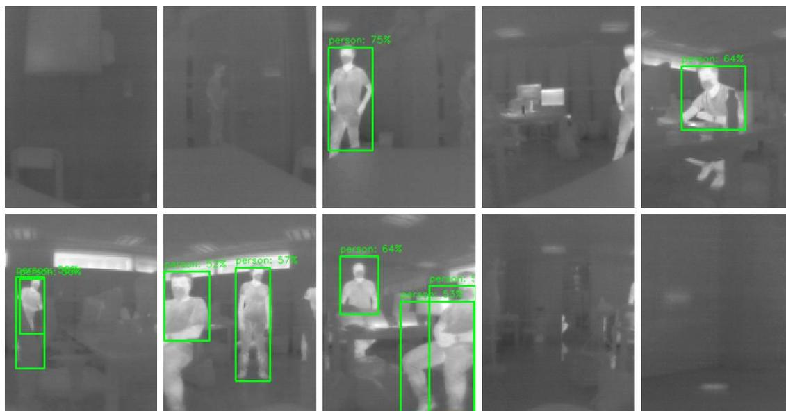
Figura 5.1: Exemplo das dez capturas de imagem numa rotação na câmara térmica
