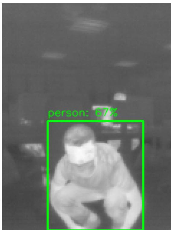
Figura 5.12: Detecção positiva por confirmação com imagem térmica
