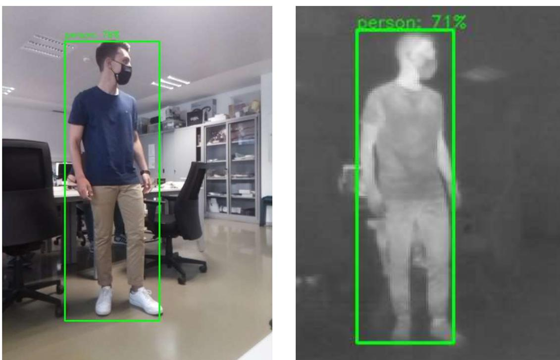
Figura 5.9: Verdadeiro Positivo na deteção em imagem RGB com confirmação térmica
