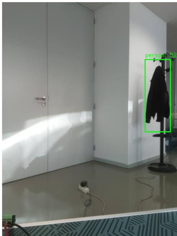
Figura 5.5: Falso Positivo na deteção com imagem RGB com um objeto semelhante a uma pessoa
