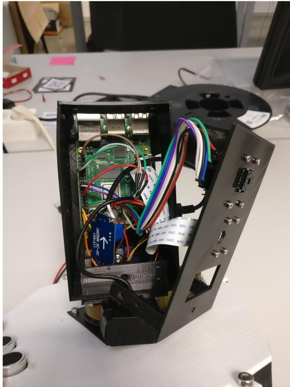
Figura 4.4: Resultado final da montagem elétrica do módulo superior
