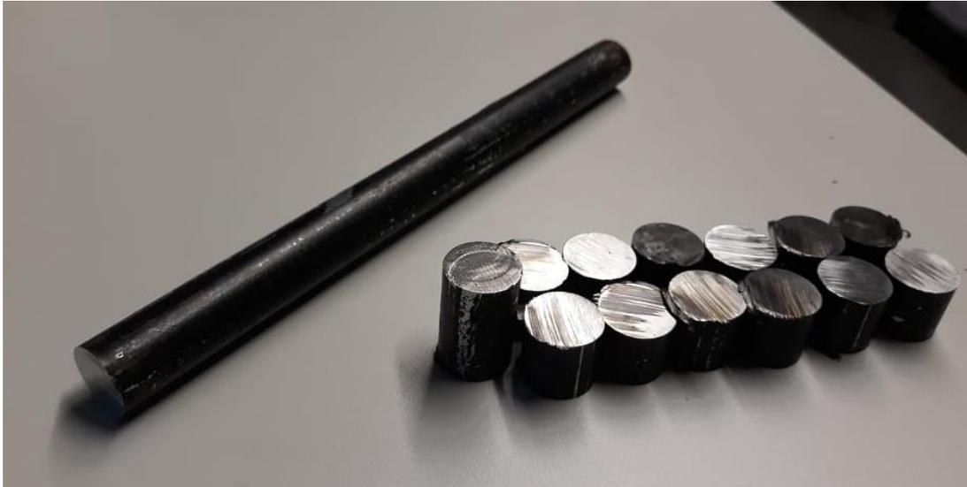
**Figura 12** - Amostras do aço AISI H13 cortadas com o discotom.
