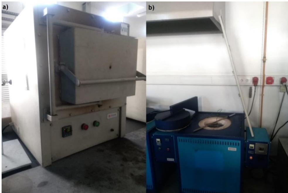
**Figura 13** - Fornos utilizados nos tratamentos térmicos. a) mufla para austenitização das amostras e b) banho de sais para a transformação bainítica.
