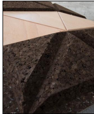
Fig. 3.12 – Exemplo de uma das amostras em aglomerado negro de cortiça e madeira, que foi utilizada para avaliar a influência da geometria e do material em relação as propriedades híbridas, refletoras, absorventes e difusas [49].
