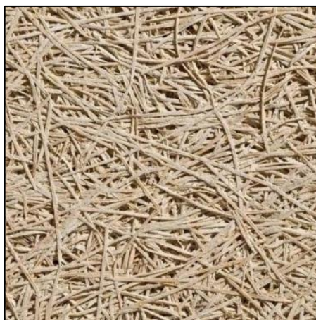
Fig. 3.6– Estrutura de uma placa de celenit (fibra de madeira) [31].
