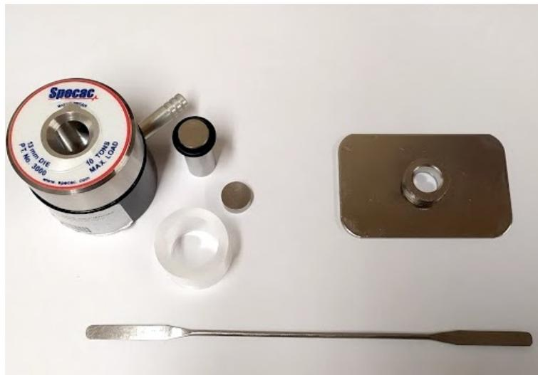
Figura 20 - Cápsula e Pastilhador utilizados na análise FTIR.
