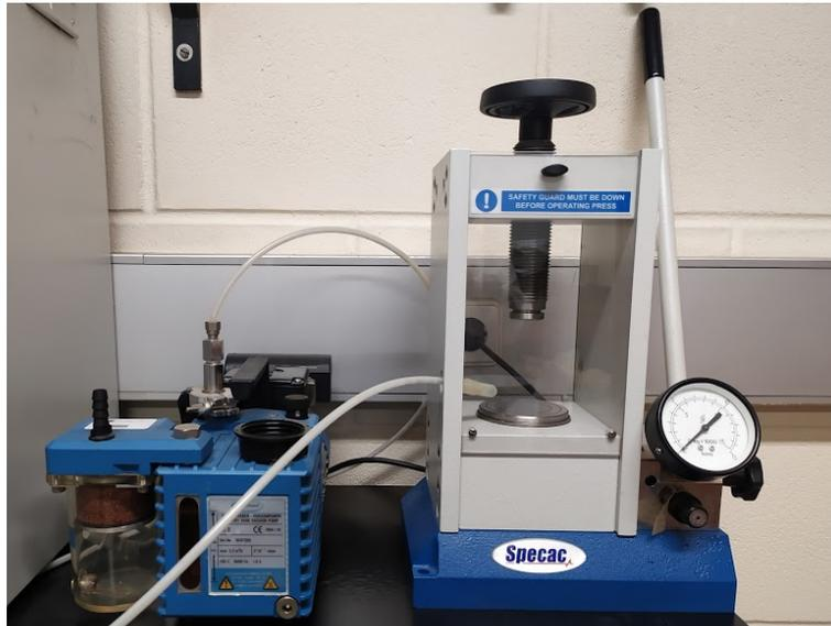
Figura 19 - Prensa SPECAC utilizada na análise FTIR.
