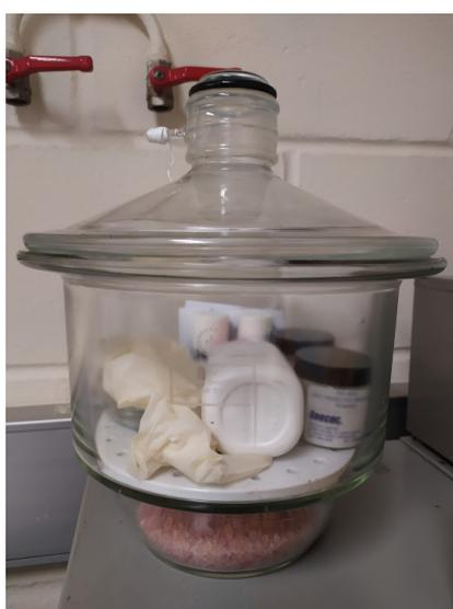
Figura 18 - Exsicador de vidro utilizado para armazenar e preservar o Brometo de Potássio (KBr) para preparação de amostras para análise de FTIR.
