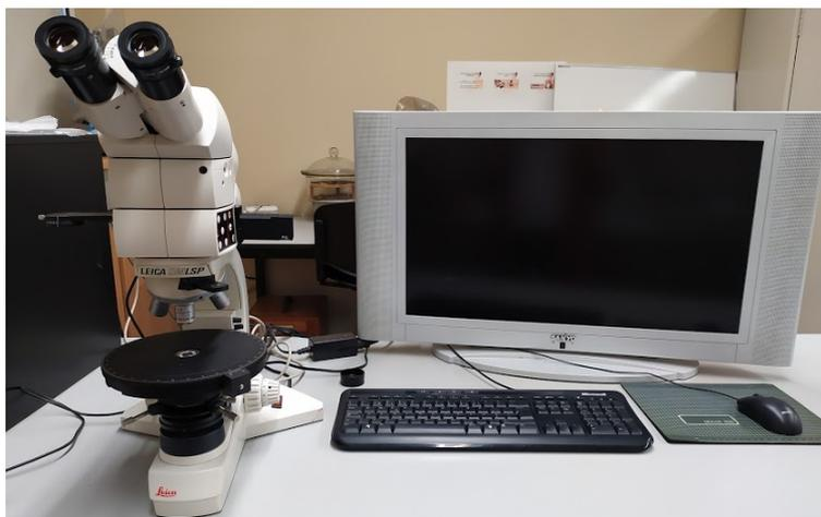
Figura 13 - Microscópio petrográfico de luz polarizada transmitida utilizado no estudo petrográfico.
