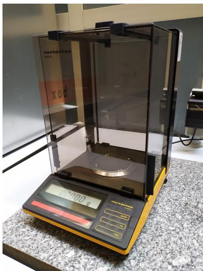
Figura 17 - Balança de alta precisão utilizada na preparação para análise de FTIR.
