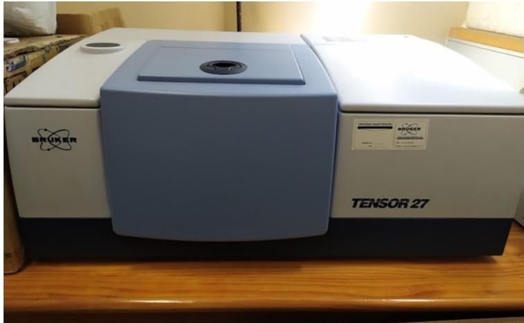
Figura 21 - Equipamento FTIR utilizado (Bruker Tensor 27).
