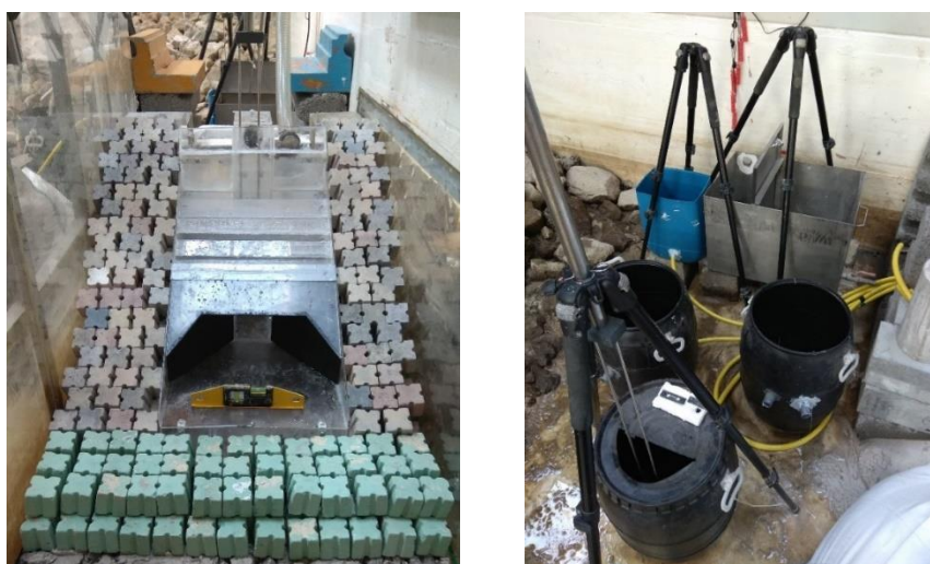
Figura 94 – Disposição do modelo físico para os ensaios da Série 2, 2W e 3 (esquerda) e ligação aos cinco reservatórios auxiliares (direita).
