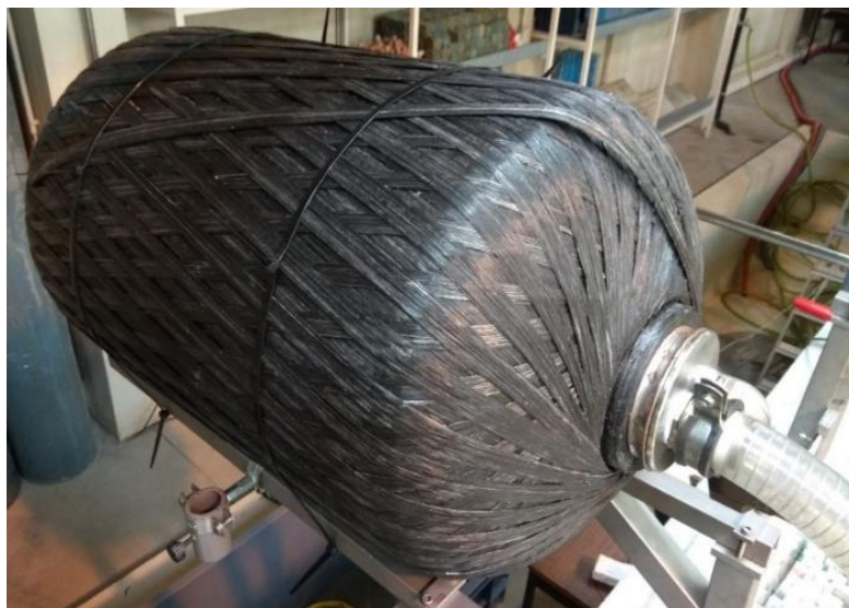
Figura 88 – Reservatório auxiliar para simular a compressibilidade do ar.
