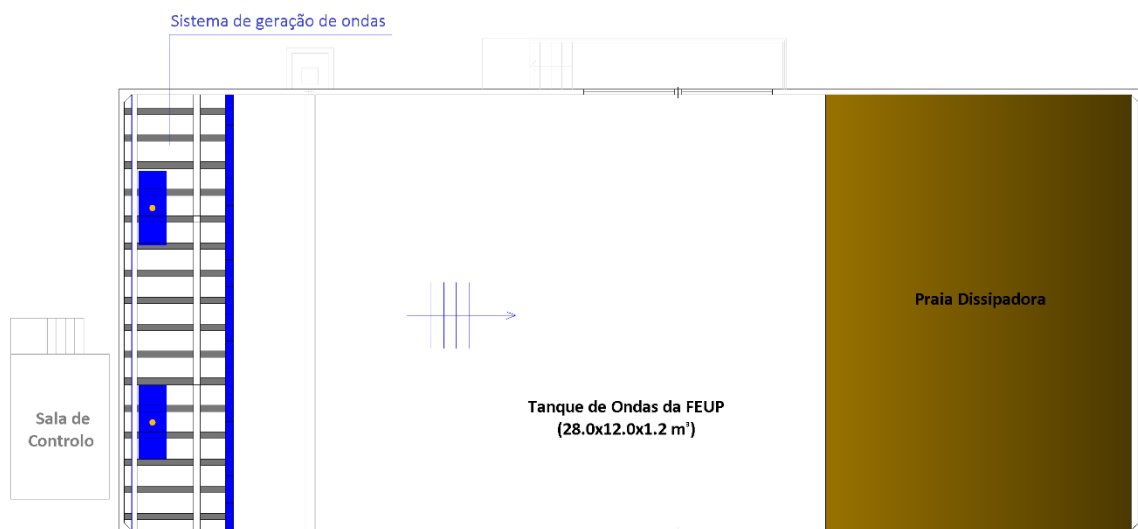
Figura 70 – Esquema do tanque de ondas do Laboratório de Hidráulica da FEUP (SHRHA, 2018).
