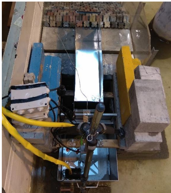
Figura 75 – Sistema de captação do caudal de galgamento da estrutura.
