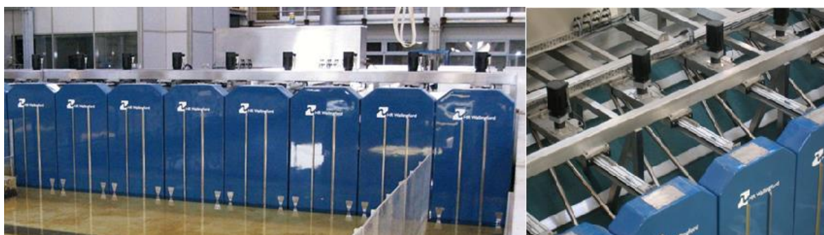
Figura 72 – Sistemas de geração de agitação marítima do Laboratório de Hidráulica da FEUP (Taveira-Pinto et al. , 2007).
