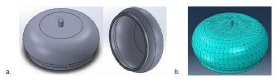
Figura 1. a. Modelo da ventosa Malmström em 3D. b. Malha de elementos finitos.
