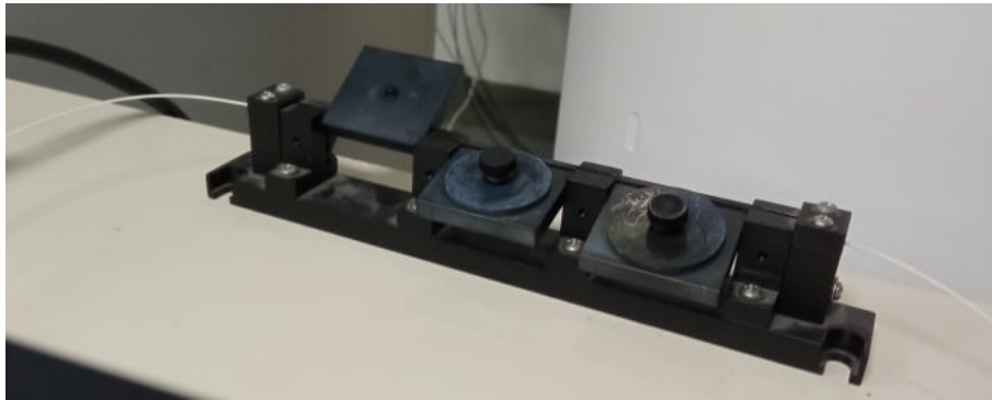
Figura 4.8: Orientação utilizada no controlador de polarização
