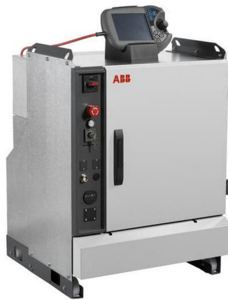
Figure 3.6: ABB IRC5 Controller [28]
