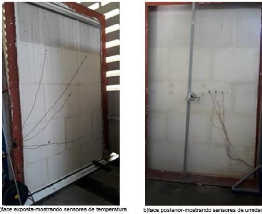
Figura 44- Aspecto das faces exposta e posterior a ação do choque térmico no 5º ciclo
