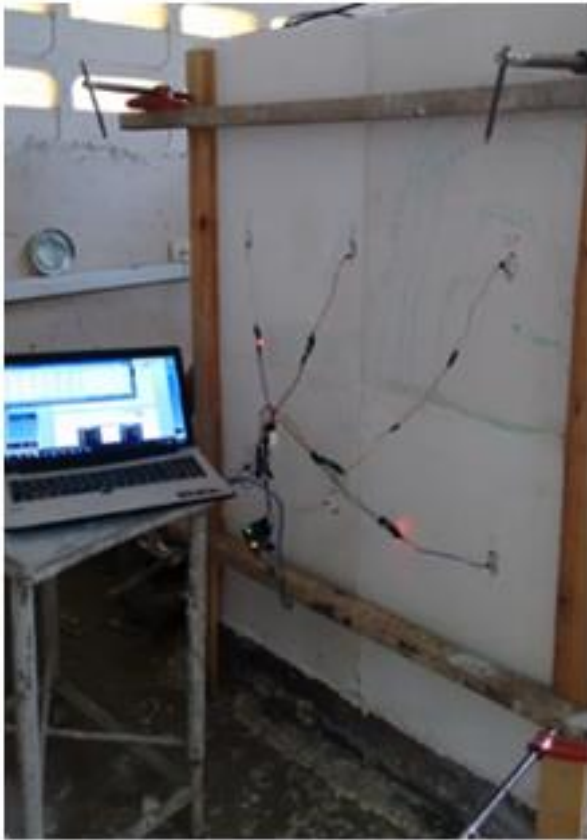
Figura 84- Aspecto do registro das infiltrações e programa de registro da umidade
