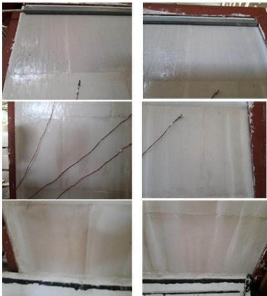
Figura 40-Detalhes da face exposta após conclusão do 1ºciclo do choque térmico
