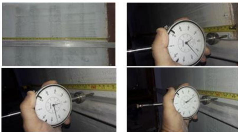
Figura 65- Aspecto de medição de desgaste superficial bloco pseudo hidro
