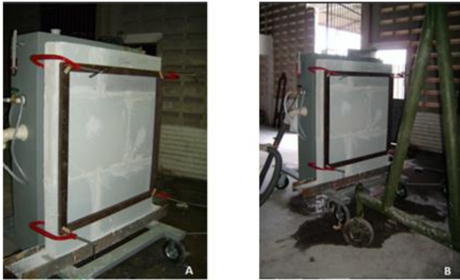
Figura 76- teste de estanqueidade em parede de blocos hidro
