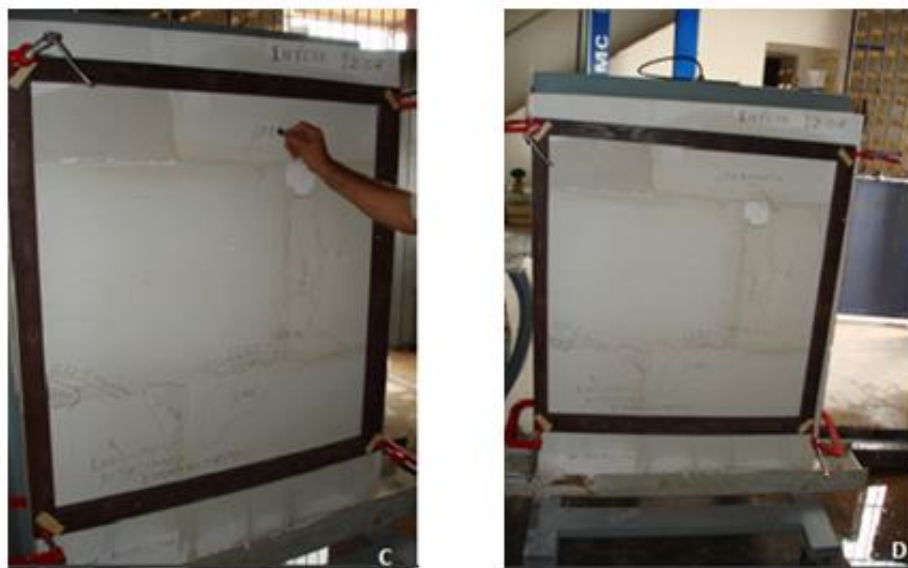
Figura 77- Teste de estanqueidade em parede de blocos standard sem tratamentos-
