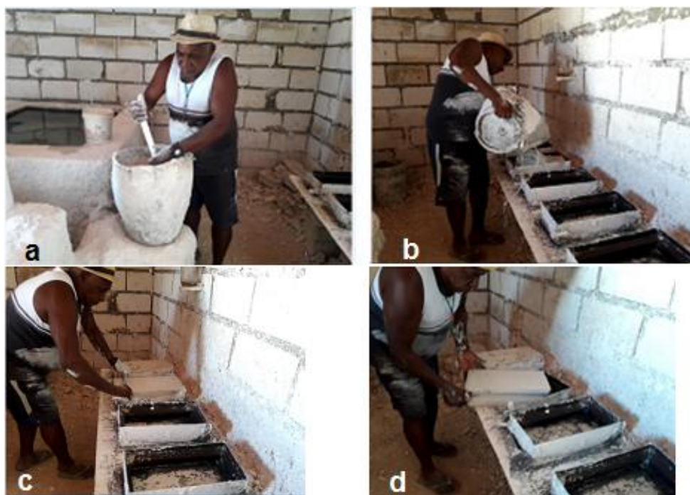
Figura 15 Processo de fabricação artesanal de bloquetes
