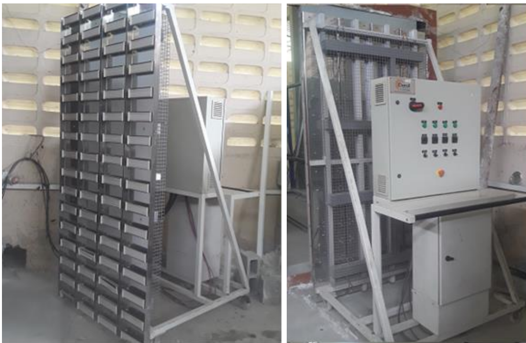
Figura 22-Equipamento de aquecimento utilizado nos ensaios de choque térmico
