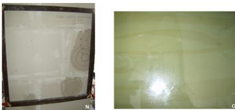
Figura 82-Teste de estanqueidade parede de blocos standard com fundo preparador e tinta acrílica
