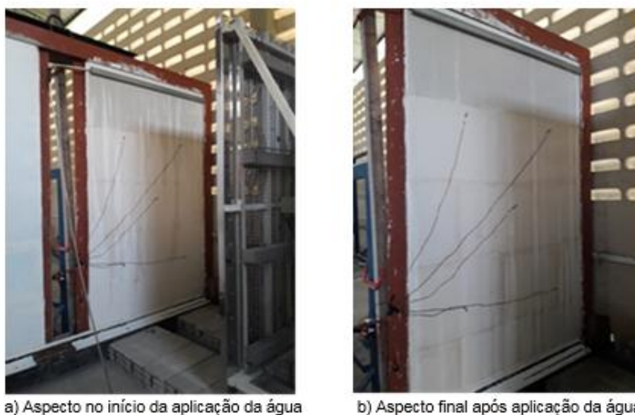
Figura 39-Aspectos inicial e final da face exposta da parede após ação da temperatura e da água
