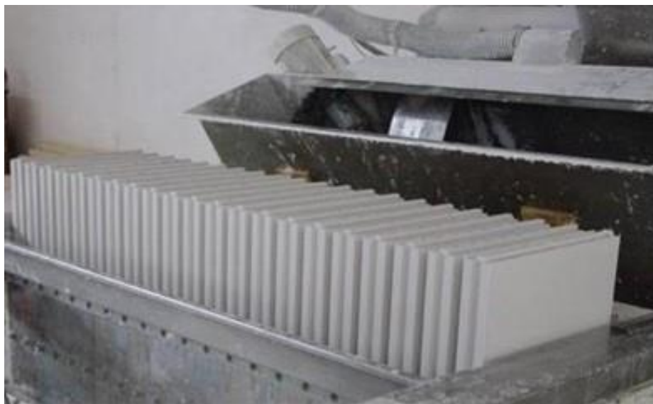
Figura 14- Fabricação de blocos pelo processo mecanizado (Gesso Trevo 2016)
