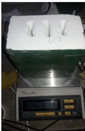
a) pesagem do espécime com sensores instalados
