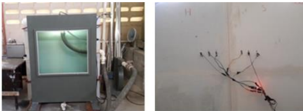
Figura 70-Aspectos da parede durante ensaio de estanqueidade
