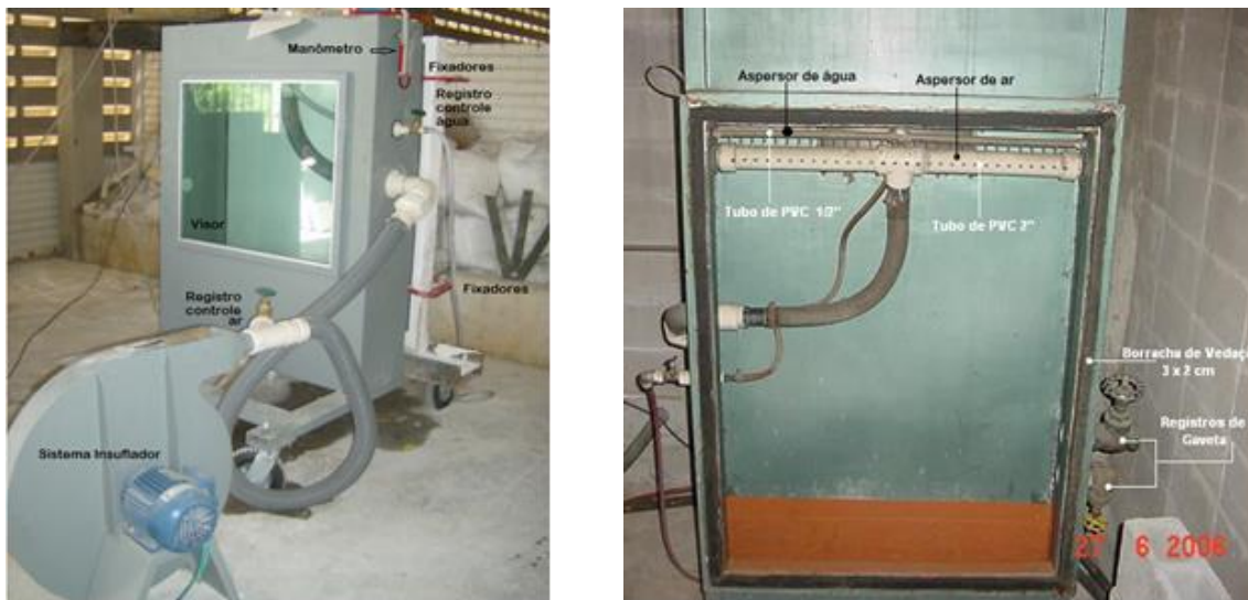
Figura 25- Detalhes do equipamento utilizado nos testes de verificação à estanqueidade à água
