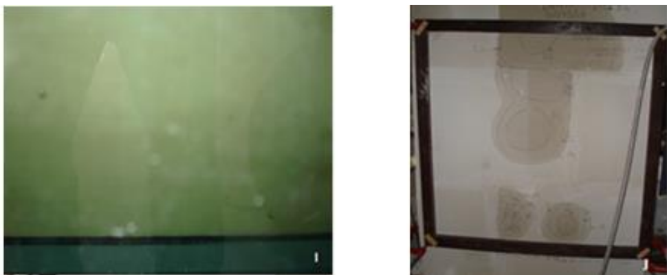
Figura 80- Teste de estanqueidade parade de blocos standard com selador acrílico e tinta latex
