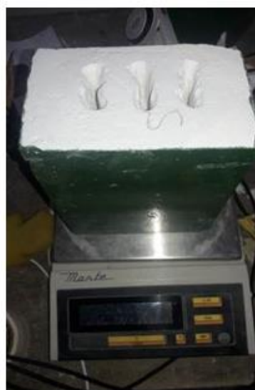
a) pesagem do espécime com sensores instalados
