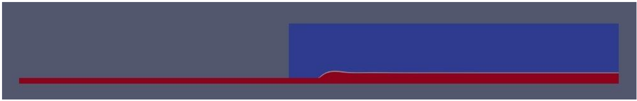
Figura 27 - Inchaço do extrudado do composto T12301 previsto com o modelo de White-Metzner ( Re=0,13 ; De=809,2 )
