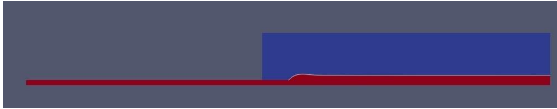
Figura 24 - Inchamento do extrudado do composto T08846 previsto com o modelo de White-Metzner ( Re=0,06 ; De=757,7 )
