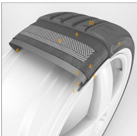
Figura 1 - Secção de corte de um pneu radial ligeiro e seus principais componentes (Continental 2015).
