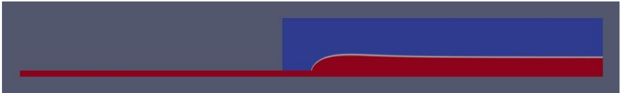
Figura 22 - Inchamento do extrudido obtido para \alpha = 0,5 ( Re=0,13 ; De=809,2 )
