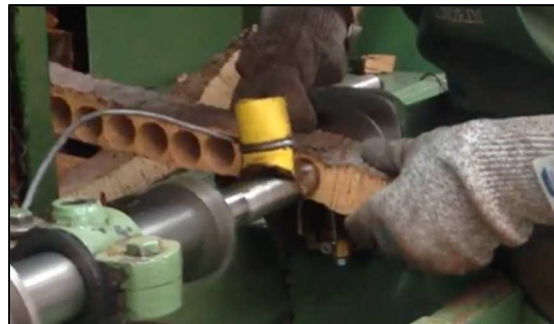
Figura 13: Operação de Brocagem na broca a pedal
