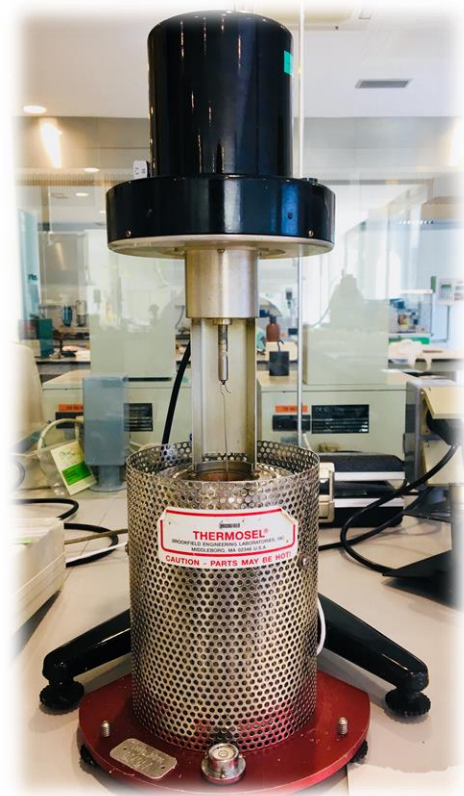
Figura 4.2 Instalação usada na determinação da viscosidade da cola
