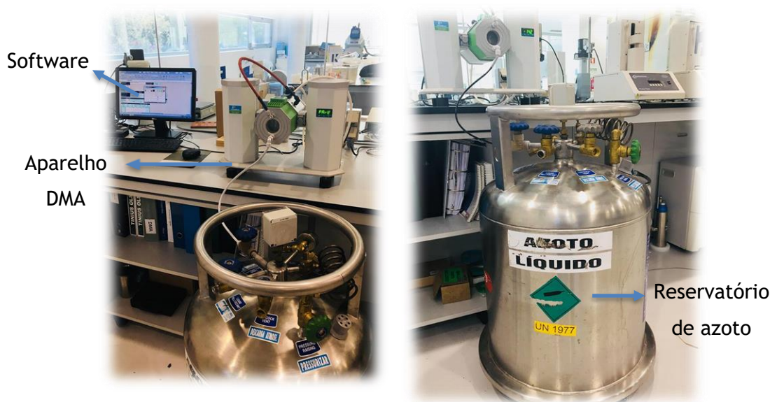
Figura 5.5. Instalação DMA usada nas experiências (computador, tecnologia DMA e reservatório de azoto)
