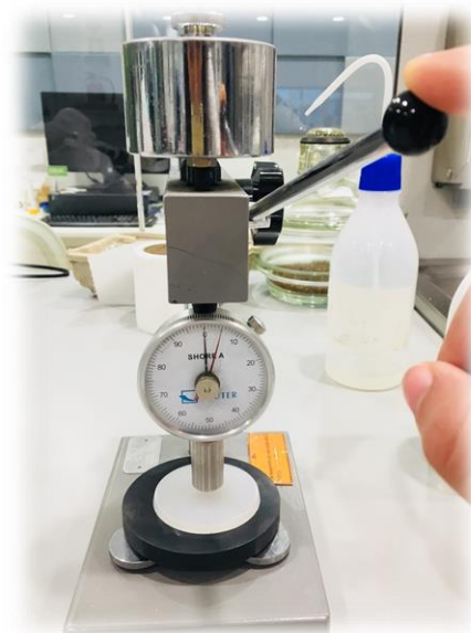
Figura 4.3 Instalação usada na determinação da dureza da cola
