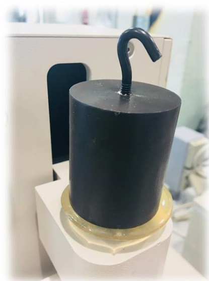
Figura 4.5 Instalação correspondente ao ensaio da pegajosidade
