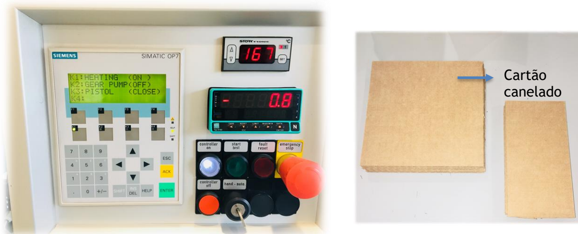
Figura 4.9 Instalação e material usados nos ensaios do tempo aberto e tempo de presa
