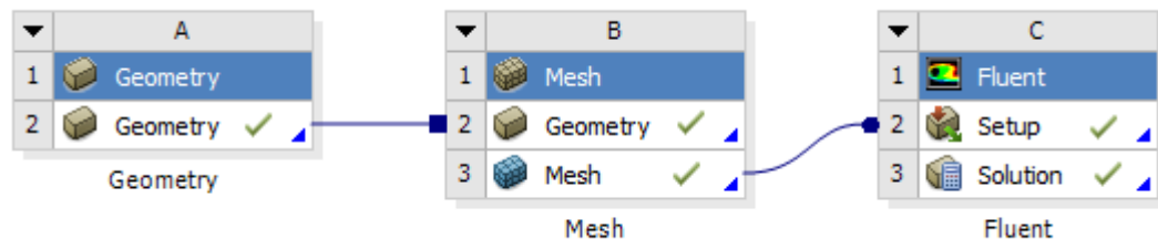
Figura 7.6 - Esquema de projeto de um problema de CFD no Workbench Ansys.
