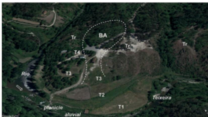
Figura 19 – Visão global dos elementos geomorfológicos principais da área do Vau numa perspectiva de imagem do Google Earth (2013/06/1), anterior à construção da barragem de Ribeiradio. T# – terraços fluviais, Tr – terraço de rocha, BA – bacia alcandorada.
