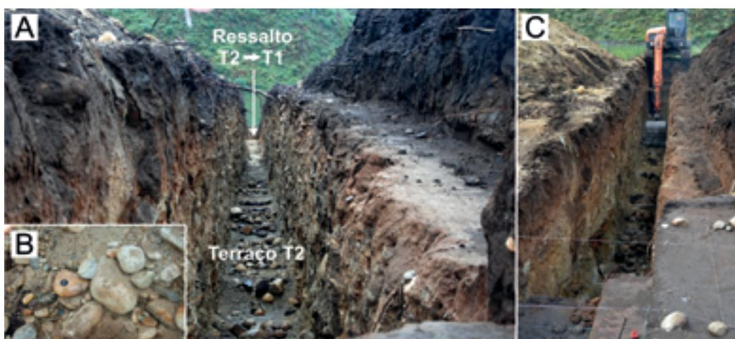
Figura 7 – Nível de terraço fluvial T2: a) perspetiva global da trincheira efetuada, individualizando-se o nível areno-conglomerático da base; b) detalhe dos seixos rolados presentes no terraço com litologias variadas; c) espessura do terraço T2 evidenciada pelo braço da retroescavadora, que escava cerca de 3m na vertical.
