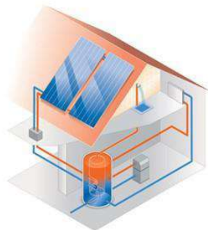
Figura 1 - Exemplo sistema solar térmico (18)
