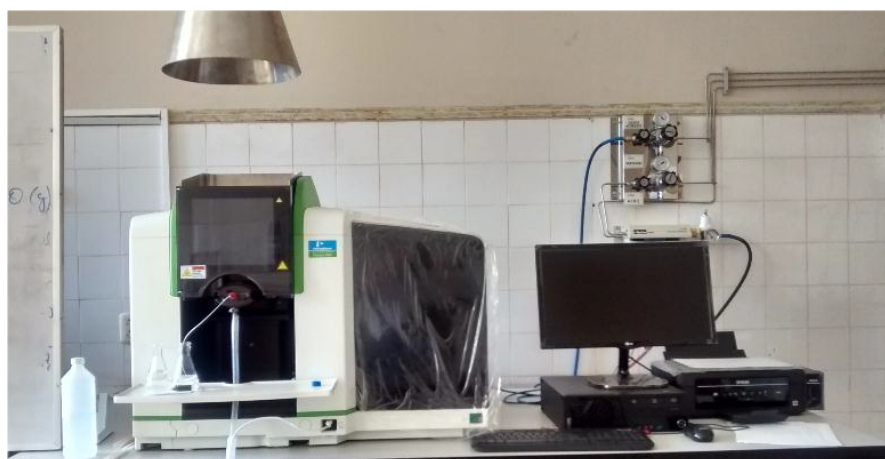
Figura 5. Equipo de absorción atómica del Laboratorio de Química Instrumental, de la Universidad Nacional de Trujillo.
