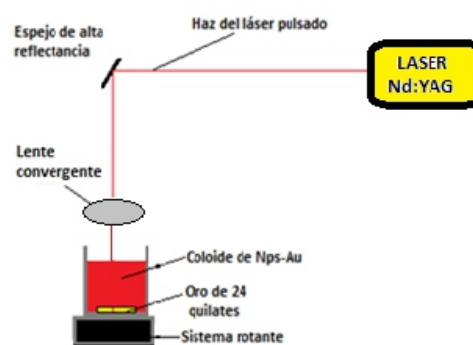
Figura 2. Esquema experimental completo para producir coloides con AuNPs, por la técnica PLAL utilizando un láser pulsado Nd: YAG.
