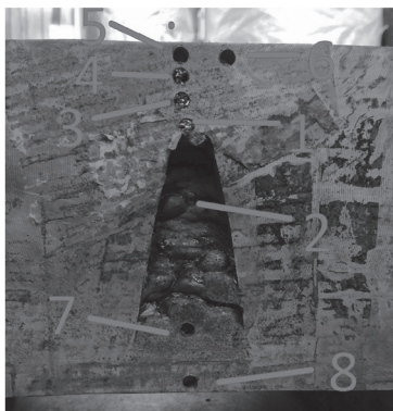
7. ábra. ICP-OES összetételvizsgálathoz végzett mintavételek pozíciója
