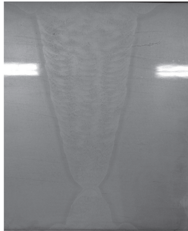
5. ábra. Többsoros varrat felépítése
