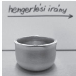
25. ábra. Kihúzott csésze a lágyított mintából
