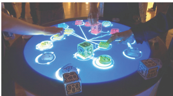
1. ábra. Reactable elektronikus hangszer megvalósítása TUI (Érintésalapú Felhasználói Interfész) segítségével. [4]
