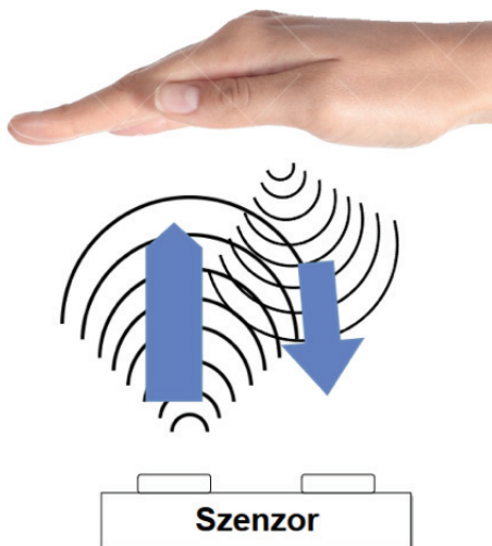
7. ábra. Távolságérzékelésen alapuló kézi gesztusvezérlés egy lehetséges megvalósítása három távolságérzékelő alkalmazásával.
