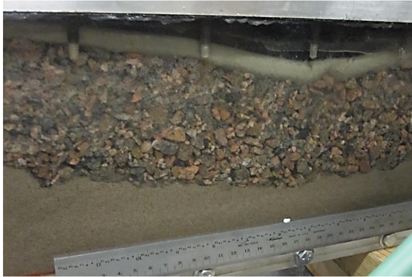
Figure 4-13 : Évolution de l'interface au cours de l'essai (écoulement de la droite vers la gauche)
