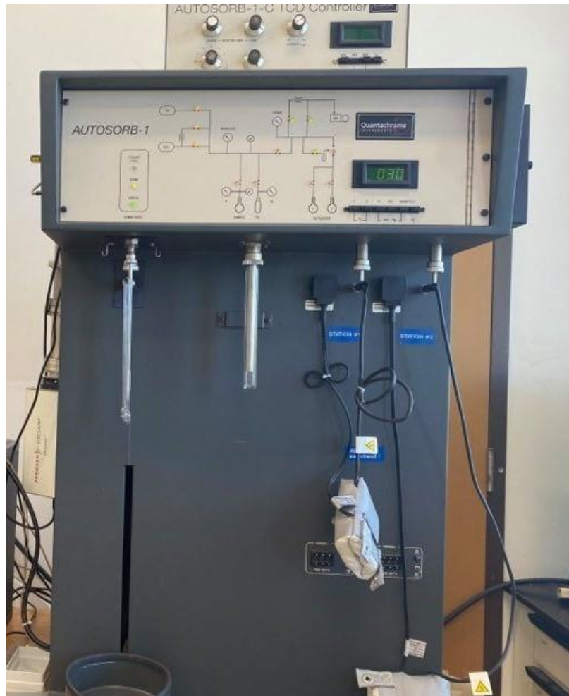
Figure 3-4 Équipement de sorption de l'azote (Autosorb-1C)
