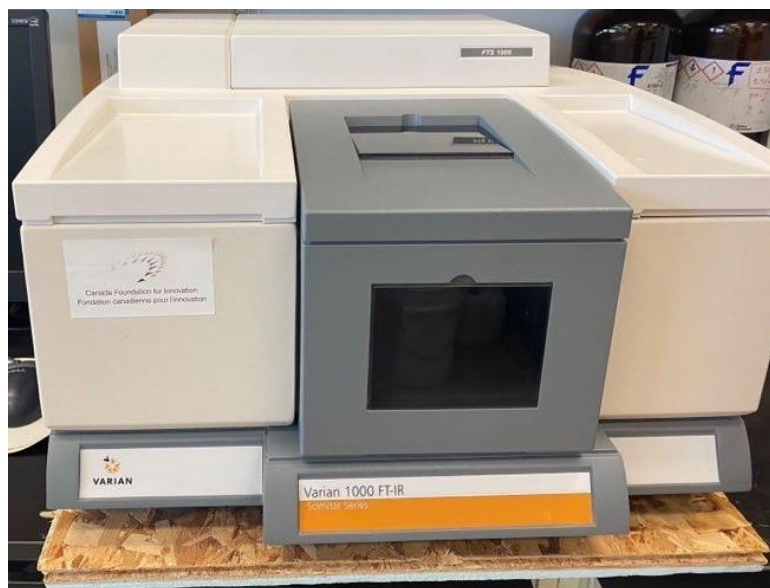
Figure 3-5. Équipement de spectrométrie infrarouge (Varian 1000)
