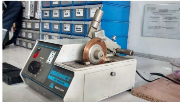
Figura 20 Equipo de Corte Hoja de Diamante
