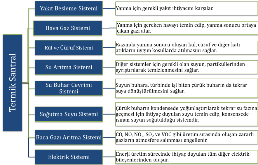
Şekil 4. Termik santral sistemleri
