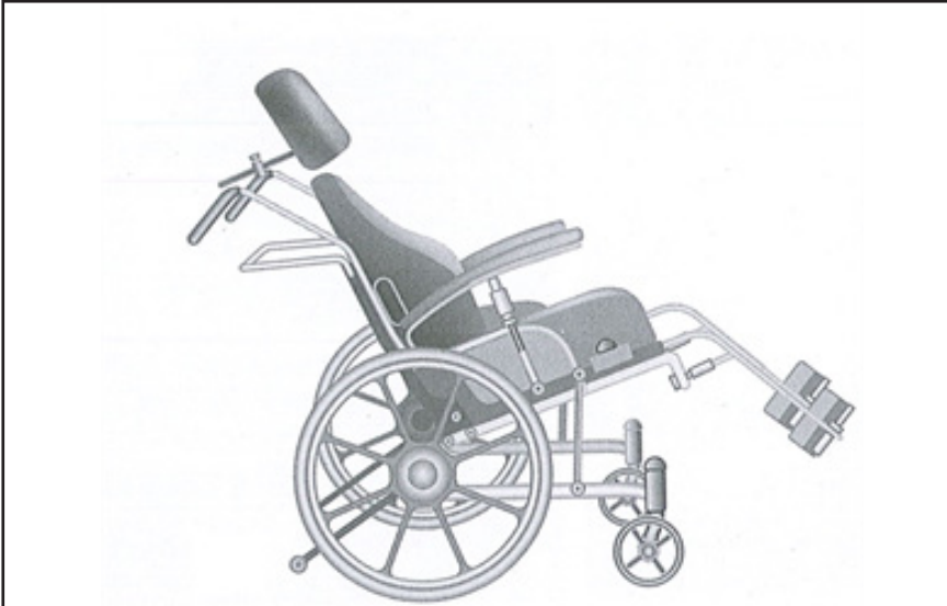
Figura 5 – Cadeira de rodas com inclinação posterior para pacientes que não apresentam controle postural de tronco
