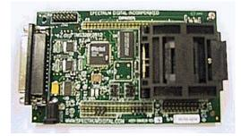
Fig. 2 : View of DSP TMS 320F2812.
