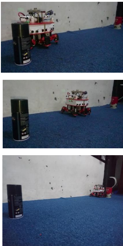
Gambar 9. Hasil Pengujian Pergerakan Robot Dengan Algoritma Tripod Gait Pada Bidang Datar.
