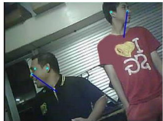
Gambar 13. Hasil Pengujian Algoritma PoseNet Lebih Dari Satu Dengan Pendeteksian Wajah Berlawanan Arah.
