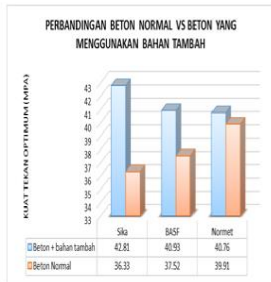
Gambar 6. Grafik perbandingan beton normal vs beton yang menggunakan bahan tambah superplasticizer
