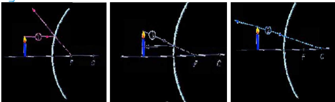
Gambar 8.17. Tiga sinar istimewa pada cermin cembung
