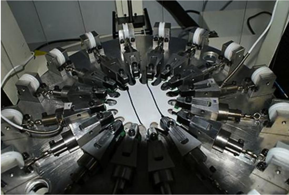
Fig 3.7 Multiaxial Testing Rig Setup (Y. A. Kvistedal, P. M. F. Nielsen).
