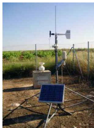
Figura 9. Estación agrometeorológica en Campo Arcís
