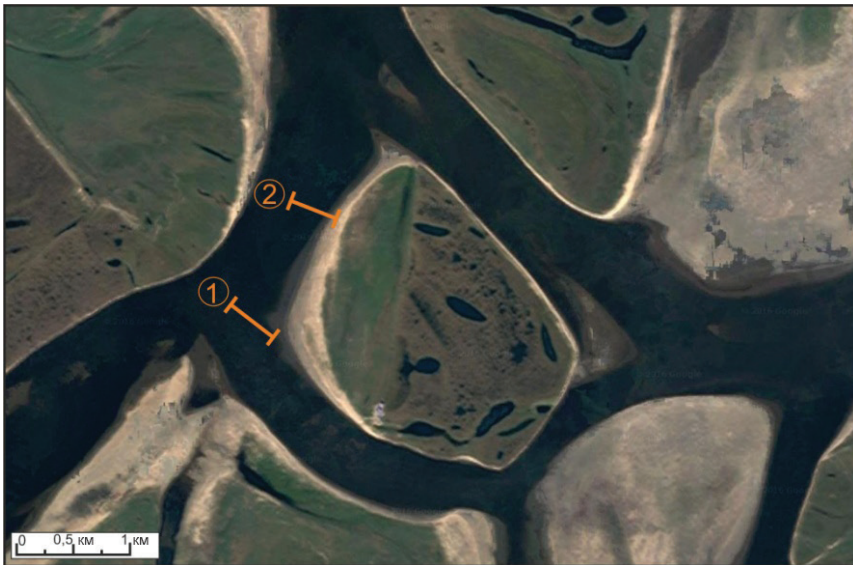
Рис. 1. Спутниковый снимок о. Самойловский, оранжевыми линиями обозначены места расположения буровых профилей.
