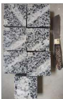
Figura 4: Amostras de Granito Cinza Andorinha com cristais bem desenvolvidos, biotita disseminada em forma de aglomerados e presença de veios de quartzo e feldspato.
