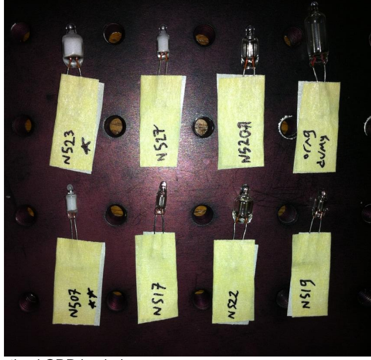
Şekil 5.7. Ölçülen ticari GDD lambaları
