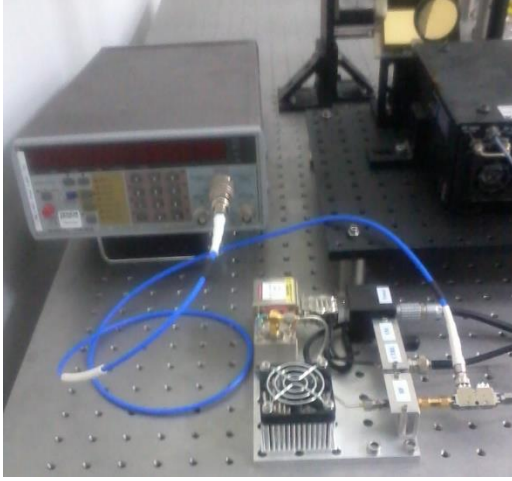
Şekil 4.3. YIG kaynağı ve 80-125GHz üretici sistemi (sol) ve GDD yapısı (sağ). 80-125GHz'teki ışının kutuplaşması ile GDD elektrik alanı paralel konumunda gösteriliyor (sağ).
