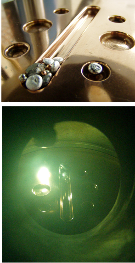
Şekil 2.6 Her ergitme operasyonundan önce bakır tabla ve vakum haznesinin içi uygun kimyasallar ile temizlenmektedir. Üstteki resimde ayrı bir buton haznede bulunan Zirkonyum metali, oksijen afinitesi oldukça yüksek olduğundan, asıl alaşım hazırlanmadan önce eritilmekte ve atmosferde bulunan eseri oksijeni de kapmaktadır.
