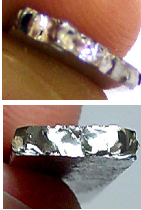
Şekil 3.27 \text{Fe}_{36}\text{Co}_{36}\text{B}_{19.2}\text{Si}_{4.8}\text{Nb}_4 (üst) ve (\text{Fe}_{36}\text{Co}_{36}\text{B}_{14.4}\text{Si}_{9.6}\text{Nb}_4)_{99.25}\text{Cu}_{0.75} (alt) hacimli metalik cam alaşımlarının 3 mm'lik kısımlarının aynamsı parkaklıktaki yüzeyleri.
