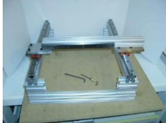
Şekil 78. İkinci Rayı Sabitlenmesi (sol), Montajın Hizalanma Gereksinimlerini Yerine Getirebilmek için Bir Plaka Kullanılmaktadır (sağ) (Durham Robotics Inc.)
