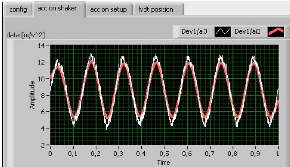
řekil 121. Sarsıcı vasıtasıyla uygulanan girdi, ivme–zaman grafięi (National Instruments).
