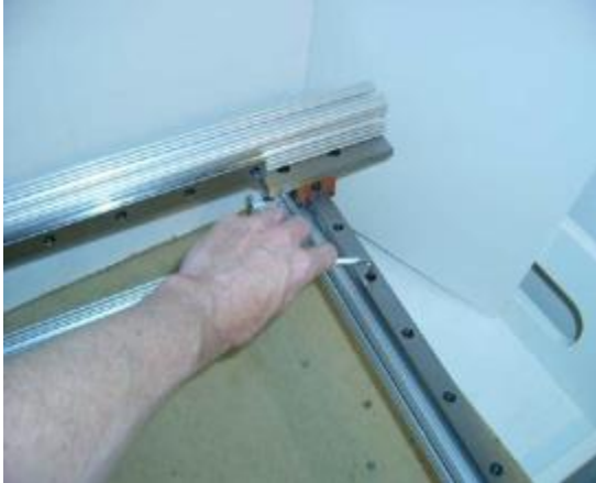
Şekil 78. İkinci Rayı Sabitlenmesi (sol), Montajın Hizalanma Gereksinimlerini Yerine Getirebilmek için Bir Plaka Kullanılmaktadır (sağ) (Durham Robotics Inc.)
