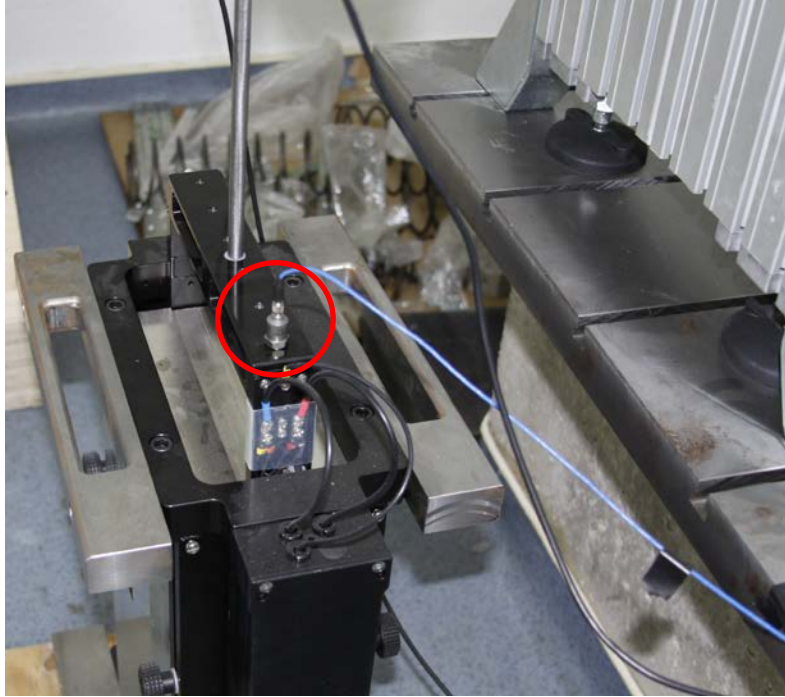
řekil 120. Sarsıcı üzerinde monte edilmiř ivmeölçer.
