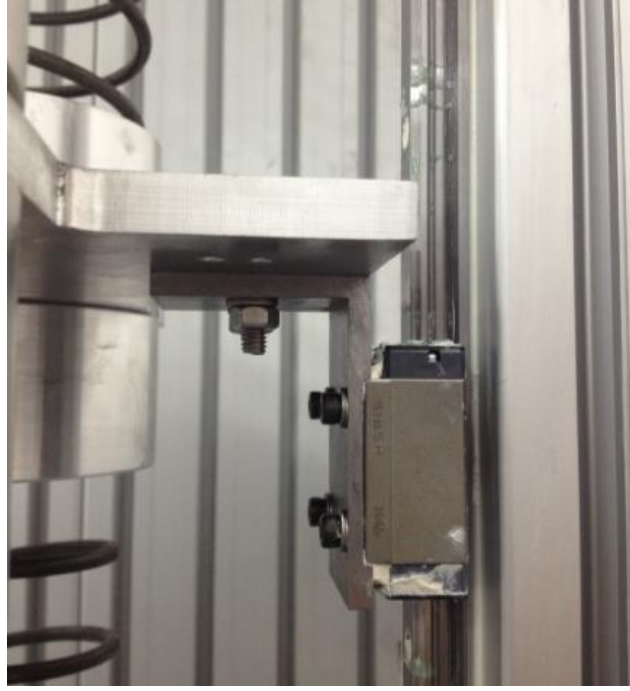
Şekil 98. Hareket eden plakalar ve doğrusal kılavuzun montajı
