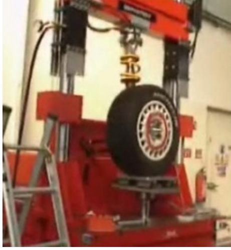
Şekil 42. ServoTest çeyrek araç test düzeneği (Langdon, 2007)
