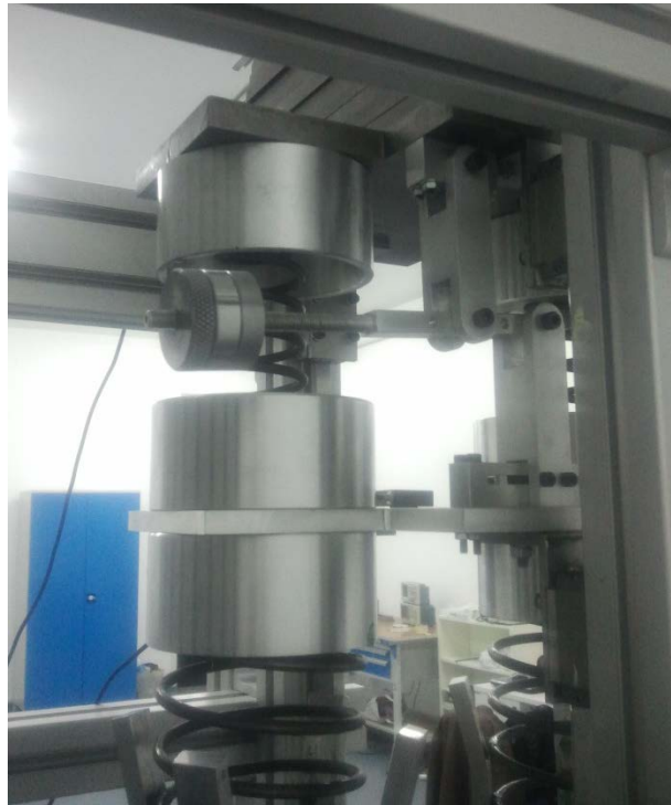
Şekil 117. Optimize edilmiş KTİ'li parçalı süspansiyon sistemi. Parçalı süspansiyon sistemine (Şekil 116) yaylanan kütle ve ayırıcı plaka aralarında KTİ eklenmiştir.
