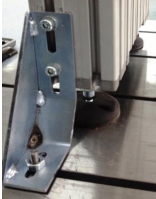
Şekil 56. Test düzeneğinin ayak bağlantı elemanlarının taban plaka üzerine bağlanması
