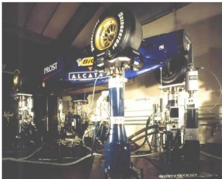
Şekil 39. Formula 1 Aracı İle Eyleyici-Tekerlek Eşleşmesi Yapılmış 7-Noktalı Test Düzeneği (Langdon, 2007)
