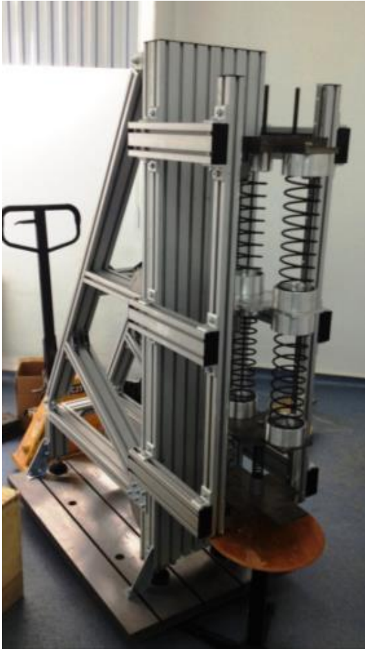
Şekil 103. İskelet yapı ve taban plaka üzerine monte edilmiş süspansiyon sisteminin çeşitli parçaları
