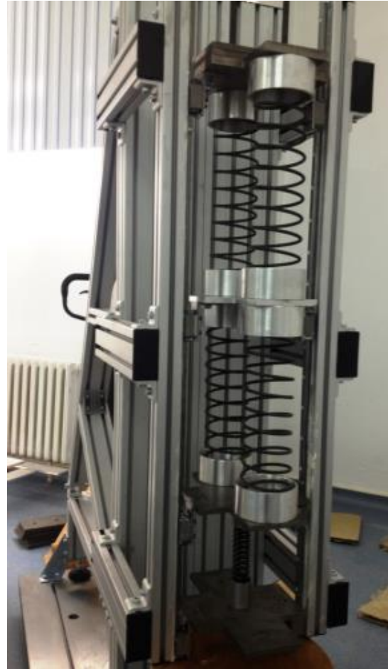
Şekil 103. İskelet yapı ve taban plaka üzerine monte edilmiş süspansiyon sisteminin çeşitli parçaları
