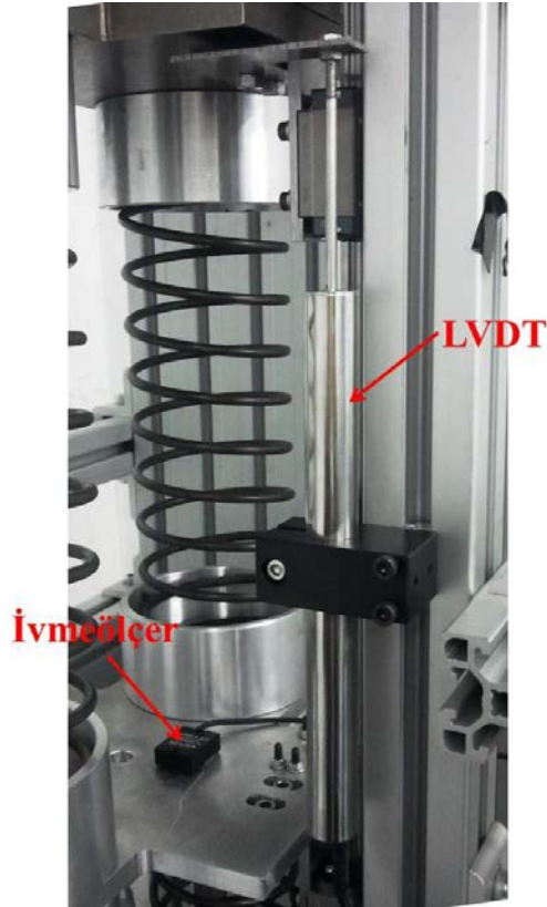
Şekil 110. LVDT ve ivmeölçerin düzeneğe montajı, ODTÜ Makine Mühendisliği Bölümü Titreşim Laboratuvarı.
