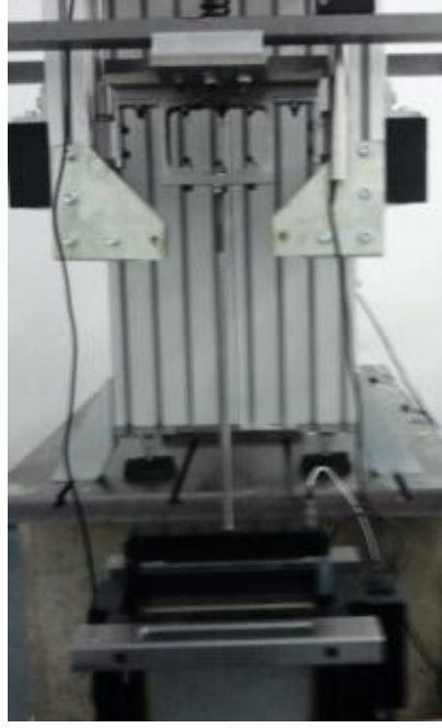
řekil 62. Sarsıcı ve sspansiyon sisteminin baęlantısı, ODT Makine Mhendislięi Blm Titreřim Laboratuvarı.
