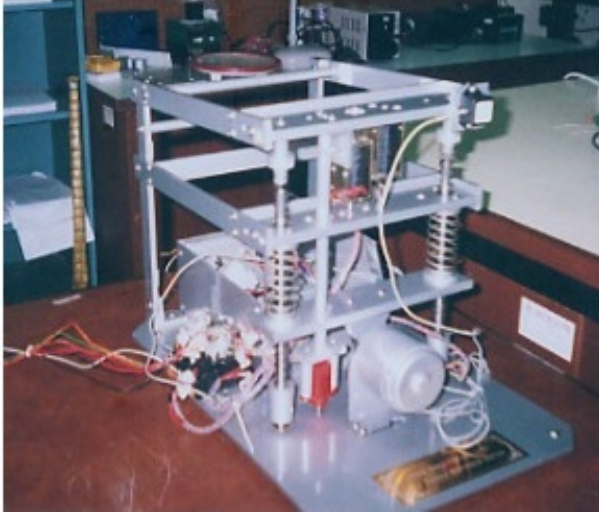
Şekil 47. Çeyrek Araç Test Düzeneği, Technical University of Malaysia (Sol) Virginia Polytechnic Institute And State University (Sağ).(Annis, 2006; GHANI, 2006)
