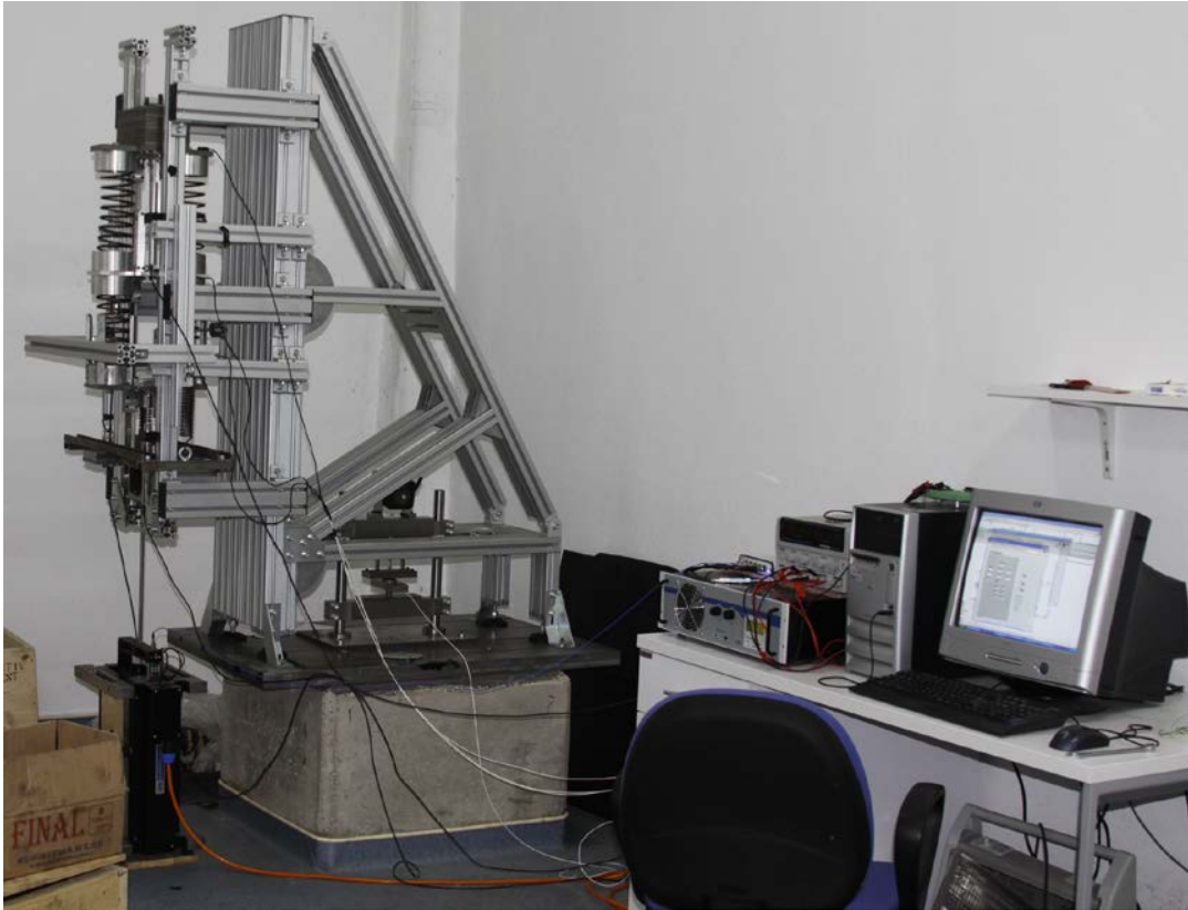
Şekil 112. Çeyrek araba modeli, ODTÜ Makine Mühendisliği Bölümü Titreşim Laboratuvarı
