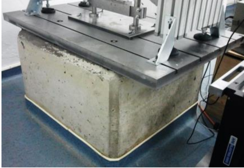
Şekil 59. ODTÜ Makine Mühendisliği Bölümü Titreşim Laboratuvarı'nda yer alan taban plaka ve beton bloğun montajı
