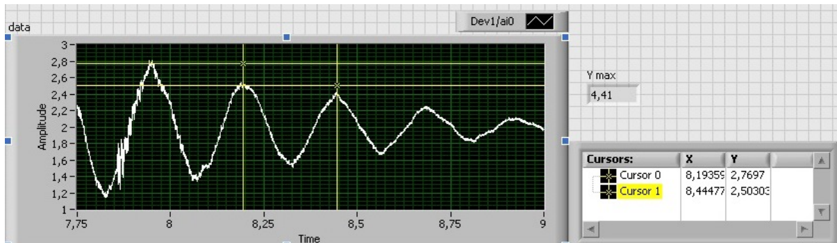
Şekil 114. Yaylanan kütlelerin ivme – zaman grafiği (National Instruments).
