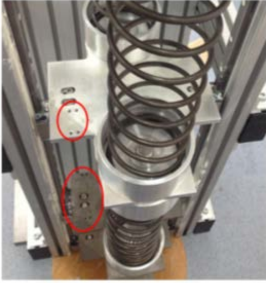
Şekil 102. KTİ'lerin montajı için plakaların üzerinde oluşturulmuş delikler
