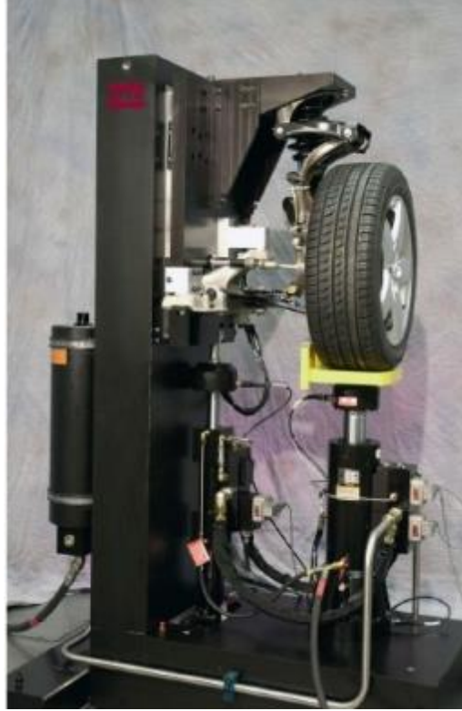
Şekil 41. MTS Mekatronik Geliştirme Ve Doğrulama Bankosu (Dan Barsness (MTS Systems), 2006)
