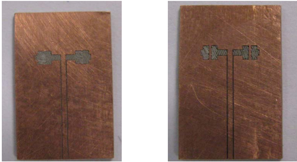
Şekil 51. Yarık Antenin MEMS Anahtar Yukarı ve Aşağı Durumu için üretilen antenler
