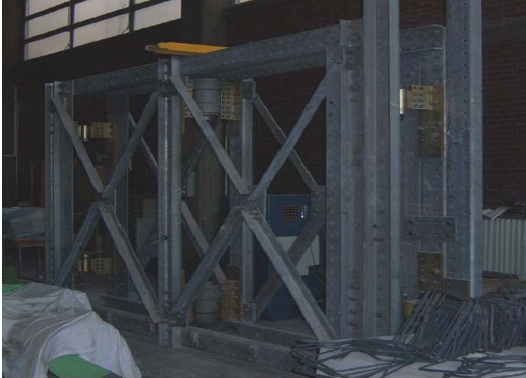
Şekil 4.1 Kendi içinde dengeli çelik yükleme çerçevesi ve hidrolik yükleme sistemi
