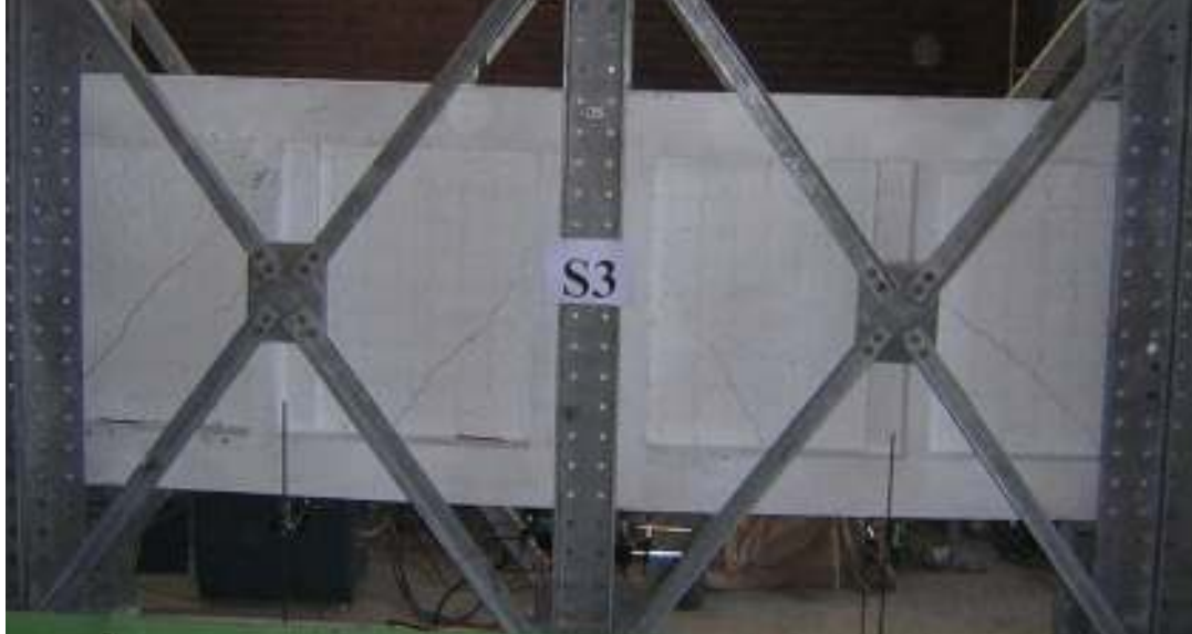
Şekil 5.28 Kat.2 dolgu duvarlarında oluşan ve hızla gelişen diyagonal çatlaklar
