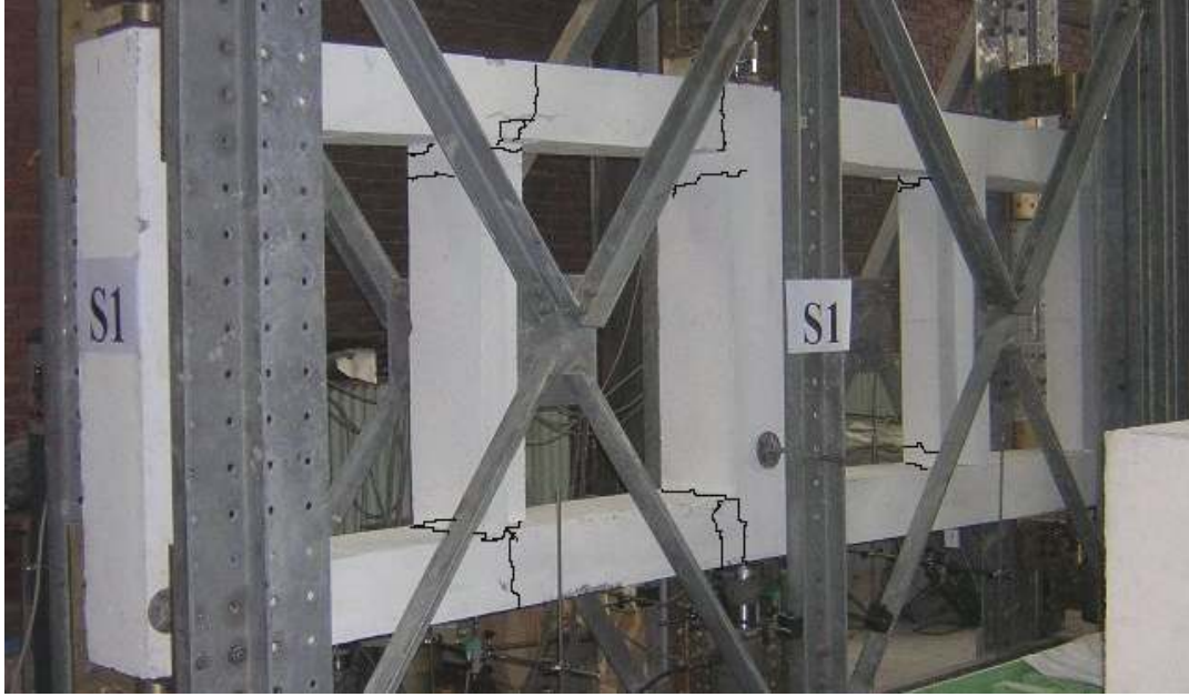
Şekil 5.12 S1 numunesinin deney sonrası durumu.
