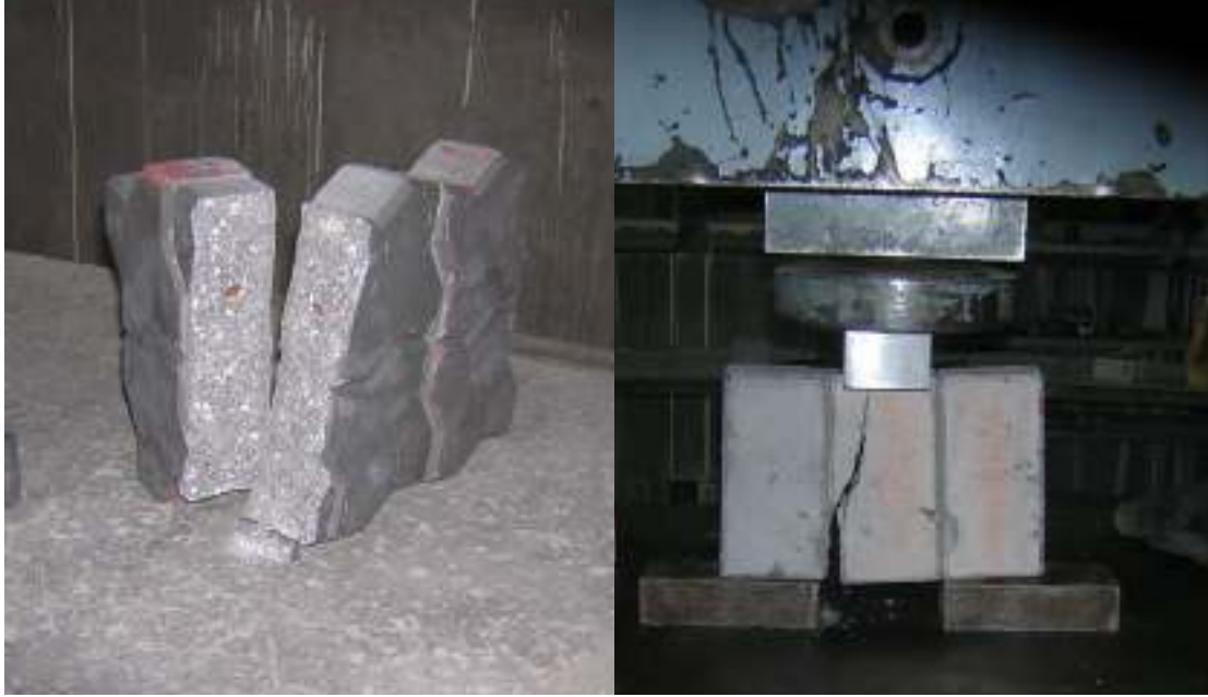
Şekil 3.14 Concresive 1406 derzli duvarın kesme yükü altındaki davranışı.
