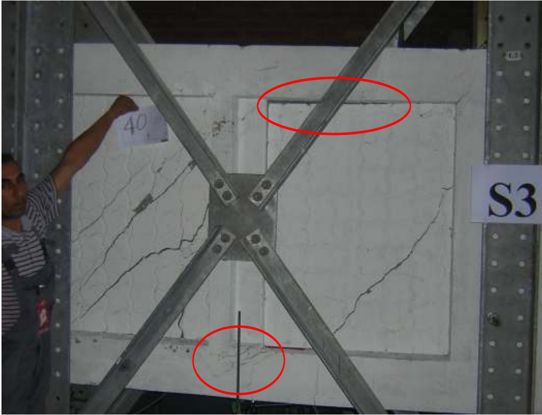
Şekil 5.29 Kat.2 dolgu duvarlarında oluşan ve hızla gelişen diyagonal çatlaklar
