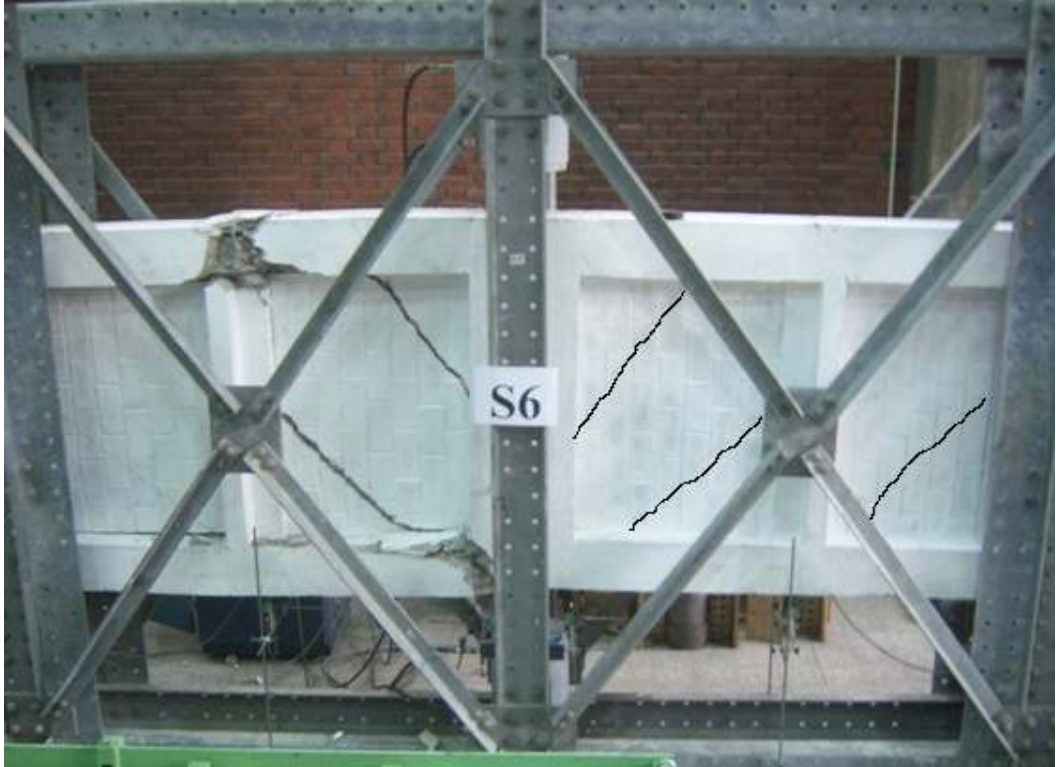
Şekil 5.60 S6 numunesinin deney sonrası görünüşü.
