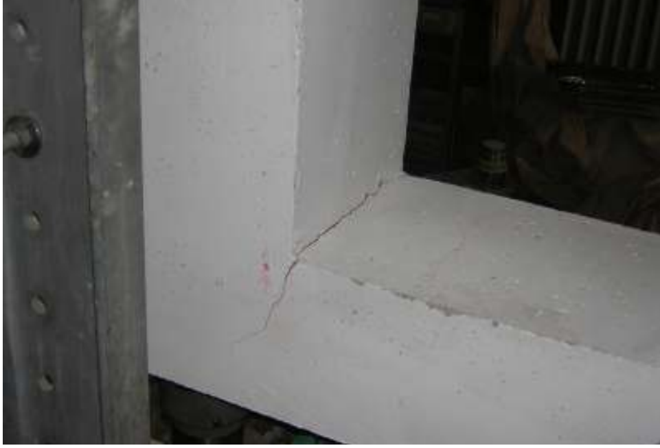
Şekil 5.7 S1 numunesi kolon-temel kirişi birleşiminde açılma.
